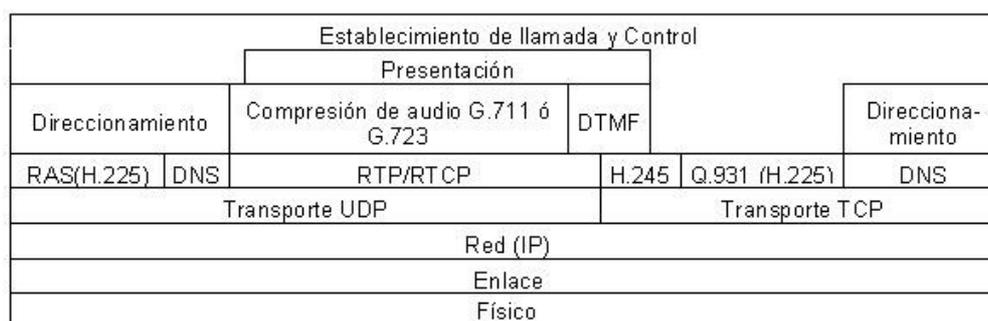
Figura 1.4 Pila de protocolos H.323 <sup>[4]</sup>
