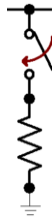
Figura 2.4 Modelo de un evento de falla en bornes del convertidor en el sistema HVDC monopolar del CIGRE en el software ATPDraw.
