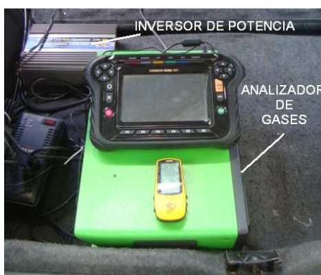
Figura 3.14 Instalación del analizador de gases.
