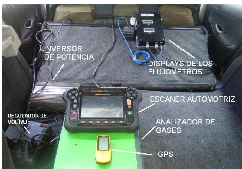
Figura 3.19 Instalación de los equipos dentro del vehículo.
