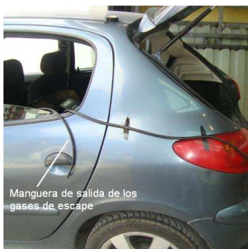
Figura 3.18 Conexión del Escáner al Analizador de gases.
