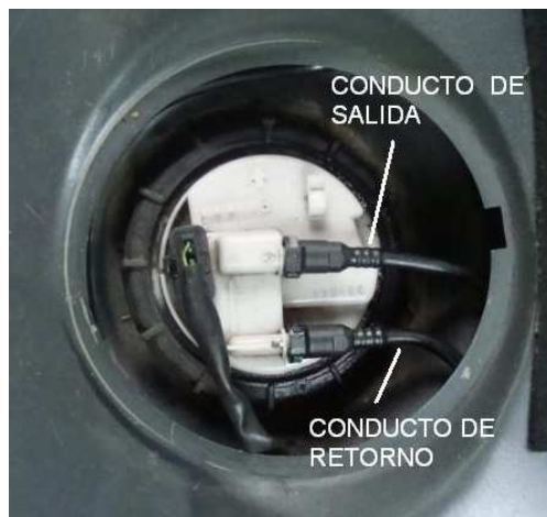
Figura 3.7 Ductos de salida y retorno en la bomba de combustible.
