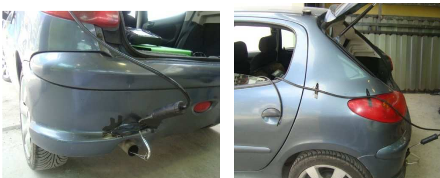
Figura 3.16 Instalación de la sonda en el tubo de escape.
