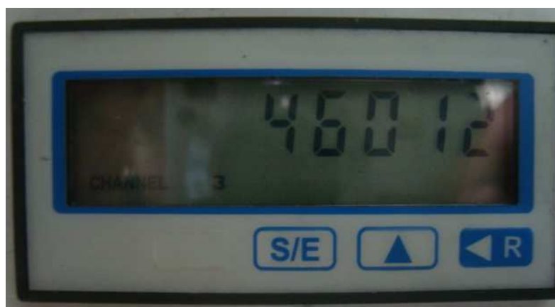
Figura 4.2 Registro marcado de pulsos de ida y de retorno de combustible.
