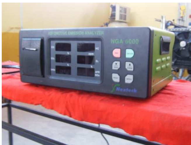
Figura 3.4 Analizador de gases.
