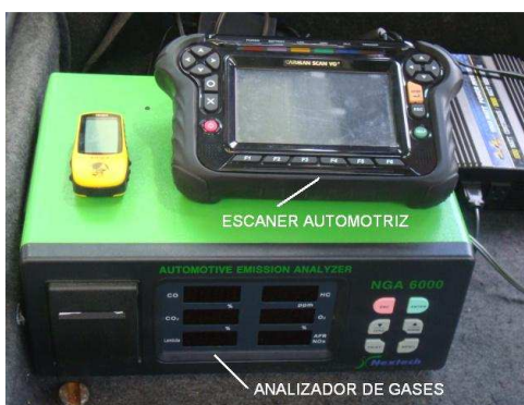
Figura 3.17 Conexión del Escáner al Analizador de gases.
