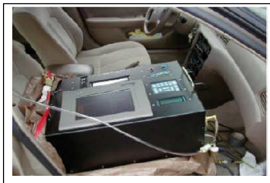
Figura 2.5 Equipo On-Board OEM-2100TM instalado en el asiento del acompañante 52
