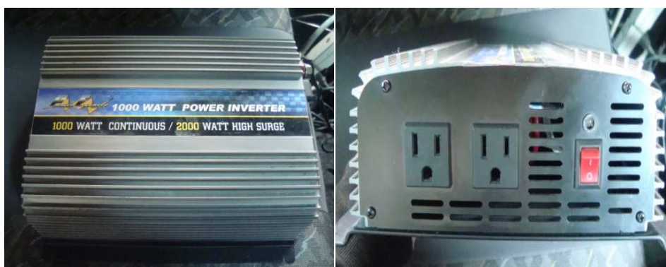
Figura 3.5 Inversor de potencia.
