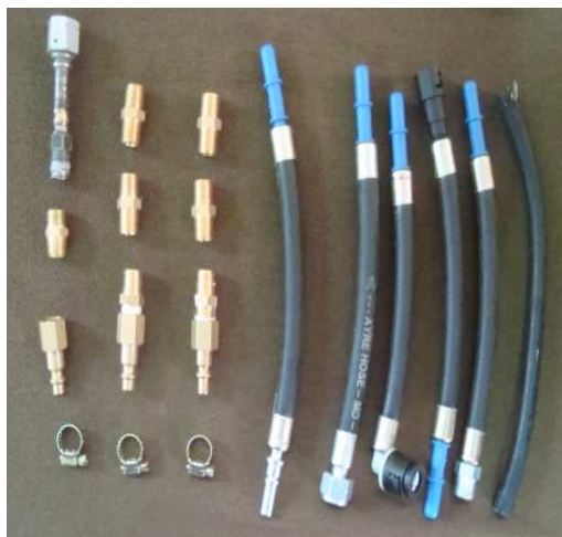
Figura 3.8 Accesorios de instalación (neplos, abrazaderas, mangueras).
