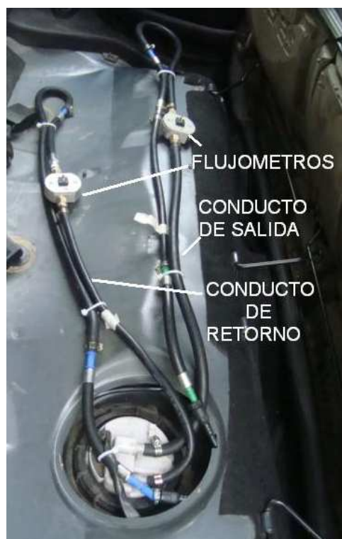
Figura 3.9 Flujómetros instalados en la bomba de combustible.
