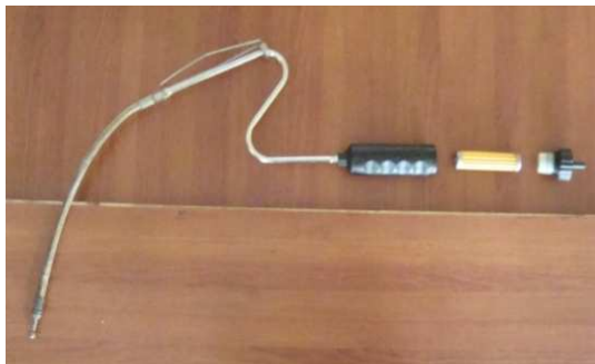
Figura 3.15 Colocación del filtro en la sonda.
