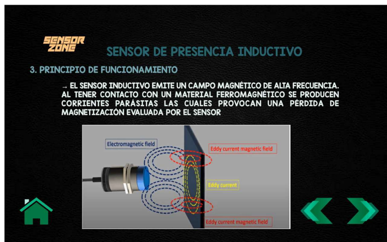
Figura 33 Breve descripción del principio de funcionamiento del sensor inductivo
