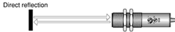
Figura 3 Funcionamiento de un sensor fotoeléctrico [6]
