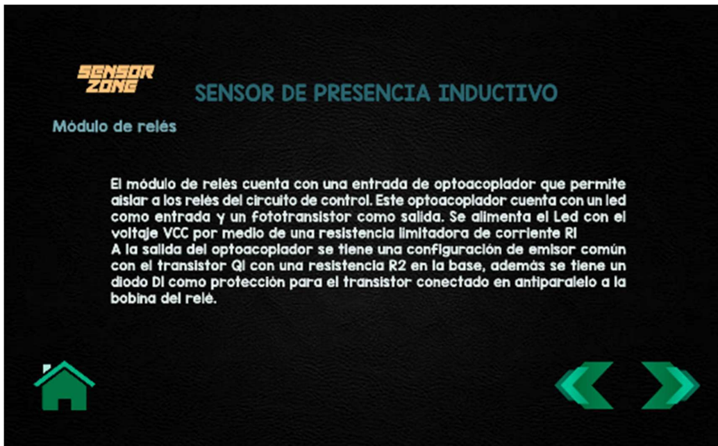
Figura 24 Información correspondiente al módulo de relés
