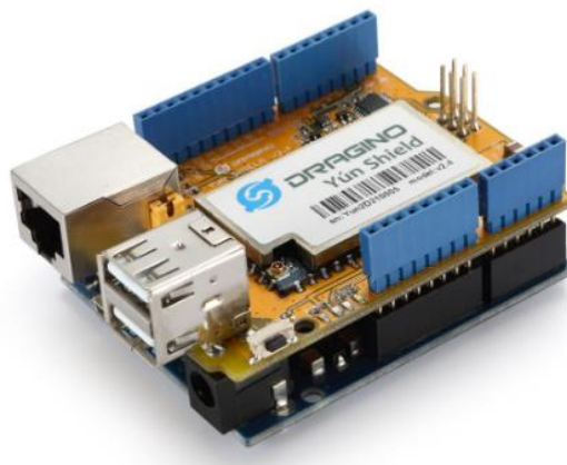
Figura 1.3. Dragino Yum Shield + Arduino UNO [18].
