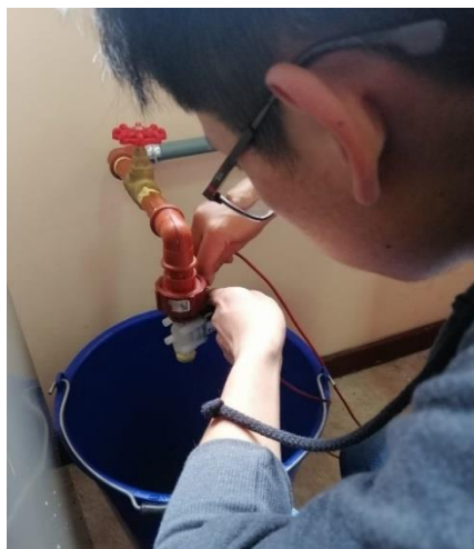
Figura 2.3. Prueba de electroválvulas en el laboratorio.
