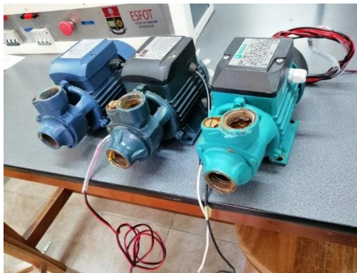
Figura 2.2. Bombas periféricas del laboratorio LTI.
