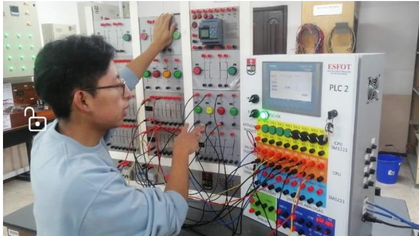
Figura 3.6. Accionamiento de entradas y salidas del PLC.
