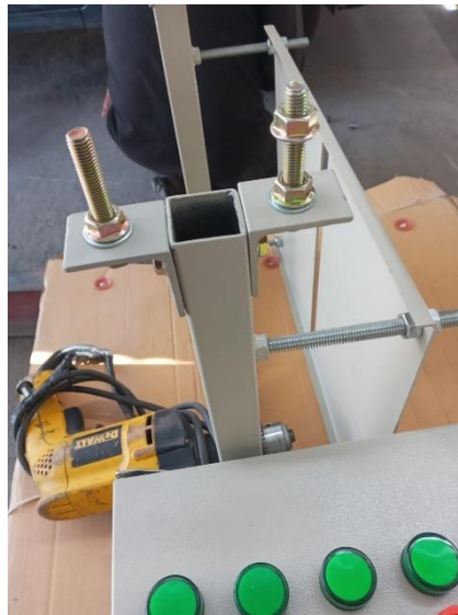
Figura 2.23. Estructura de calibración del sensor ultrasónico.
