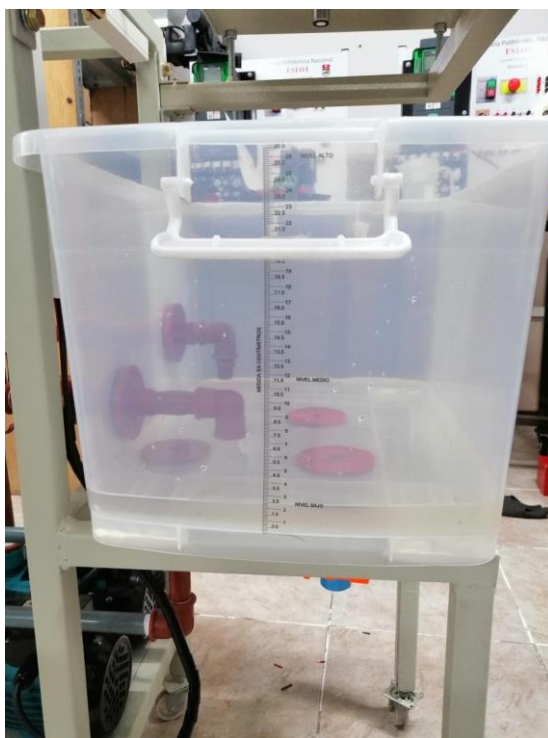
Figura 3.10. Pruebas de nivel (modo manual nivel bajo 2.5 (cm)).
