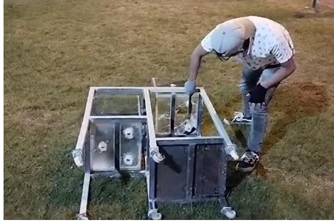
Figura 2.6. Desmontaje de los cristales de los tanques.
