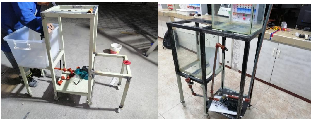
Figura 2.18. Diferencia de altura de tanques.
