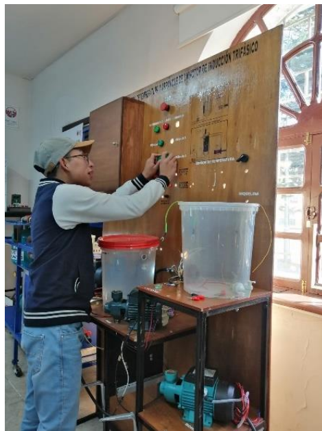
Figura 2.7. Desmontaje de pulsadores y luces piloto.
