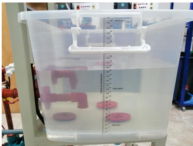
Figura 3.11. Pruebas de nivel (modo automático 16.8 (cm)).
