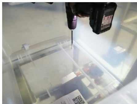
Figura 2.24. Perforaciones en tanque de plástico.
