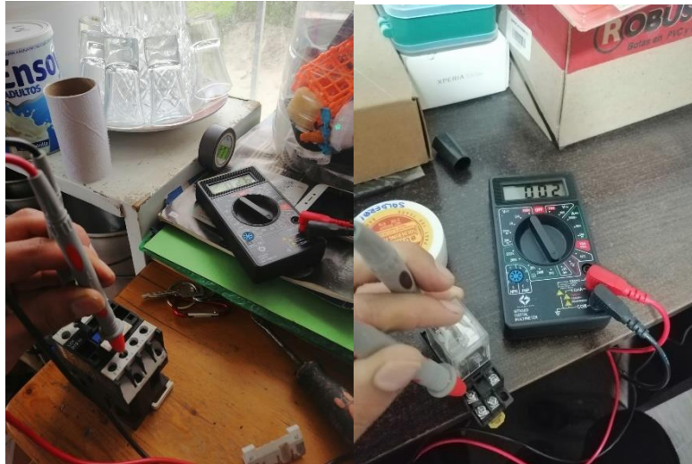
Figura 2.14. Prueba de conductividad en relés y contactores.
