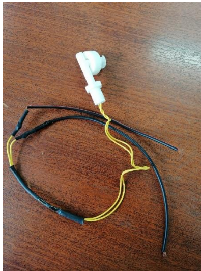
Figura 2.9. Sensor flotador tipo interruptor del laboratorio LTI.
