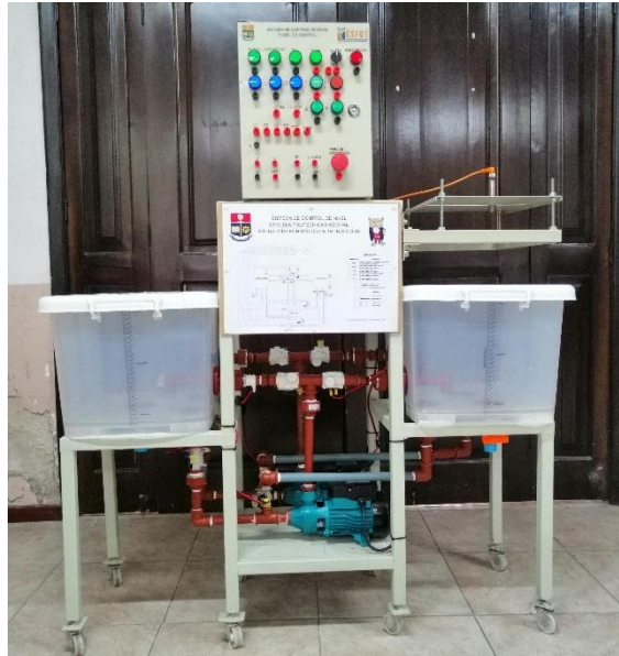
Figura 2.38. Sistema de control de nivel repotenciado.
