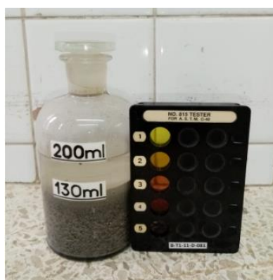
Figura 3.3 Comparación de la mezcla con la cartilla de color
