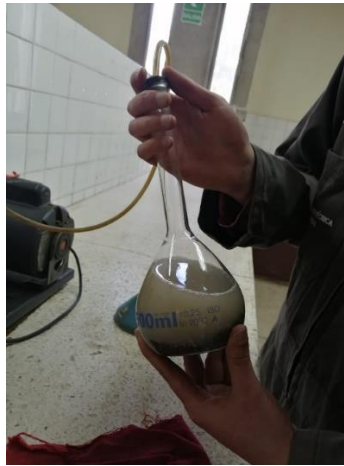
Figura 2.4 Extracción del agua con la bomba de vacío
