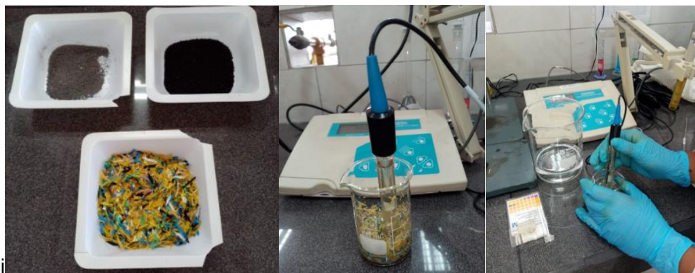
Figura 2.13 Determinación del pH de las muestras de residuos
