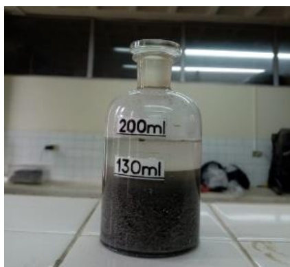
Figura 2.11 Mezcla del hidróxido de sodio con el agregado fino
