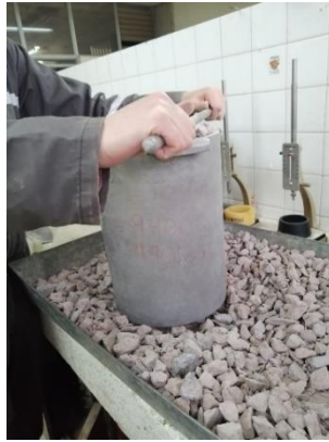
Figura 2.5 Agregado grueso siendo igualado con la altura del cilindro
