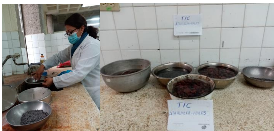
Figura VI.3 Preparación de los agregados para la determinación del peso específico.
