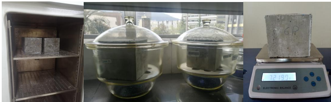
Figura 2.25 Secado de los cubos y determinación del peso
