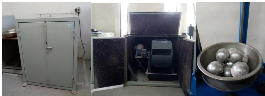
Figura 2.9 Equipos utilizados en el ensayo de abrasión
