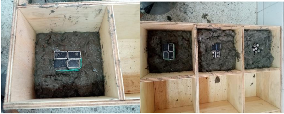
Figura 7. Encapsulamiento de las pilas y baterías
