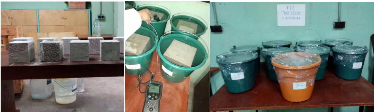
Figura 12. Preparación del sistema de lixiviación para cada dosificación y su duplicado.
