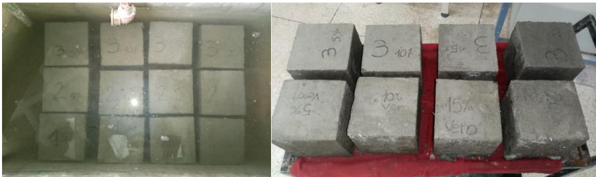
Figura 9. Curado de los cubos de hormigón con residuo encapsulado.
