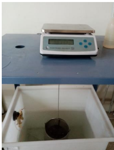
Figura VI.4 Determinación de la densidad aparente del agregado grueso.
