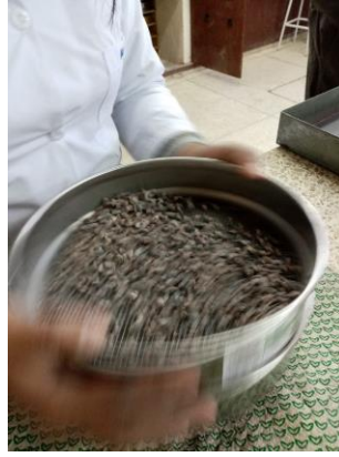
Figura 2.8 Tamizado del agregado fino
