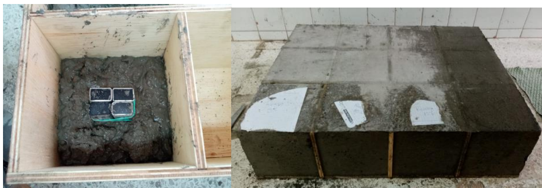
Figura 3.5 Pilas siendo encapsuladas en el centro del molde
