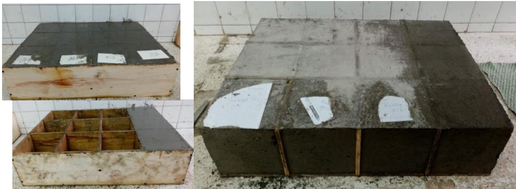
Figura 8. Desencofrado de los cubos de hormigón con residuo encapsulado.
