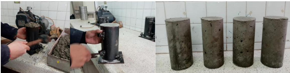
Figura 2.16 Fundición de los cilindros de hormigón
