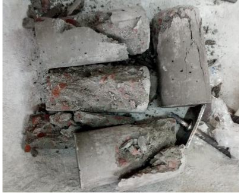
Figura 2.19 Especímenes cilíndricos luego del ensayo
