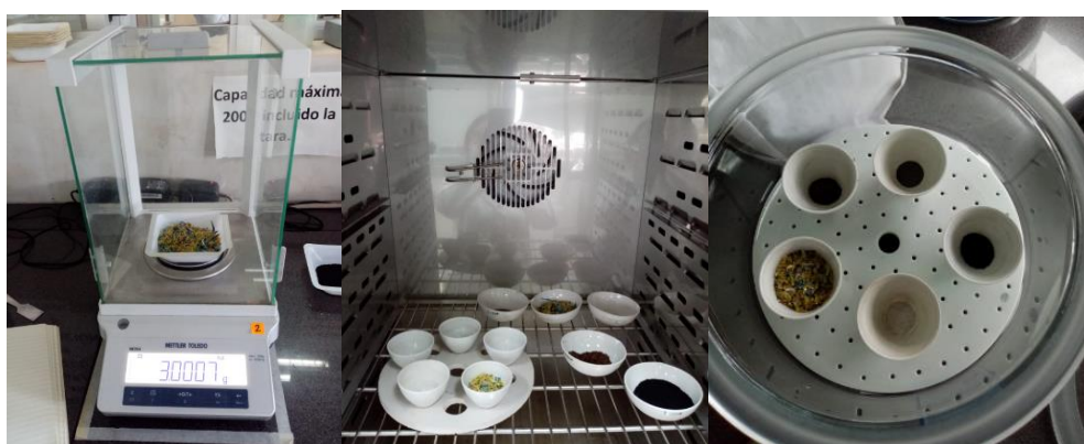
Figura VI.6 Determinación de contenido de humedad en las muestras de residuos peligrosos.
