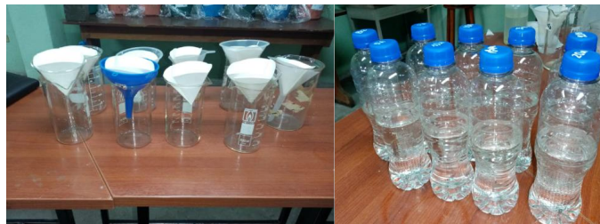
Figura 13. Envasado de las muestras de lixiviado junto con su duplicado.
