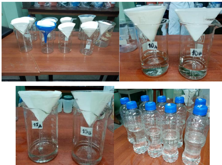
Figura VI.8 Filtrado y envasado del lixiviado de cada una de las dosificaciones con su duplicado.
