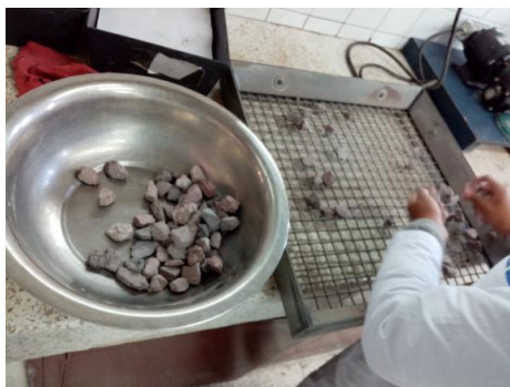
Figura 2.10 Retiro del agregado grueso retenido en el tamizador electrónico
