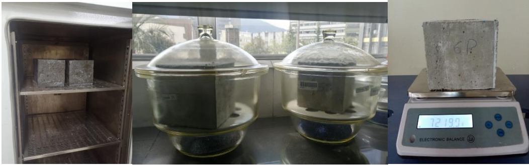
Figura 11. Secado de los cubos y determinación del peso
