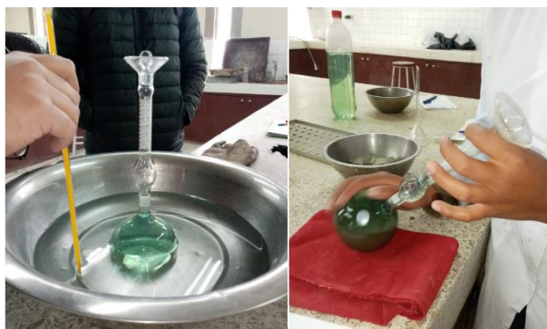
Figura 2.6 Determinación de la masa del cemento y gasolina a 23 °C
