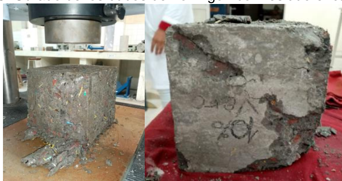
Figura 10. Cubos de hormigón con daño luego de la compresión.
