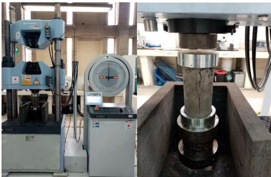
Figura 2.18 Compresión sobre un cilindro en la máquina universal de prueba
