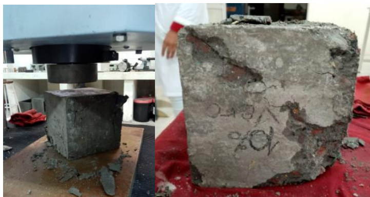
Figura 3.7 Cubos de hormigón con daño luego de la compresión
