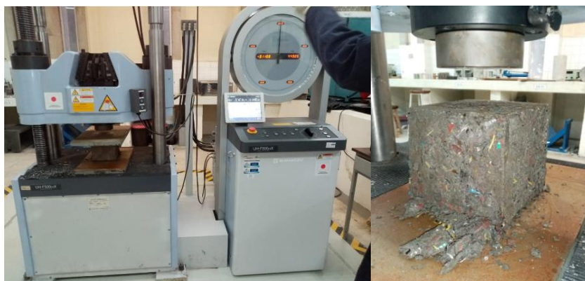
Figura 3.6 Ensayo de compresión sobre los cubos con residuos encapsulados
