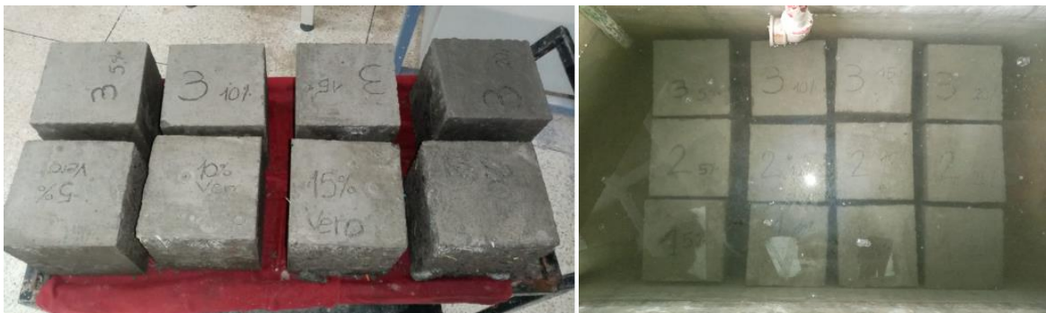
Figura 2.24 Curado de los cubos de hormigón con residuo encapsulado
