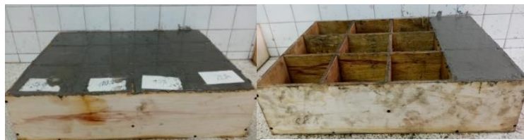
Figura 2.23 Desencofrado de los cubos de hormigón con residuo encapsulado
