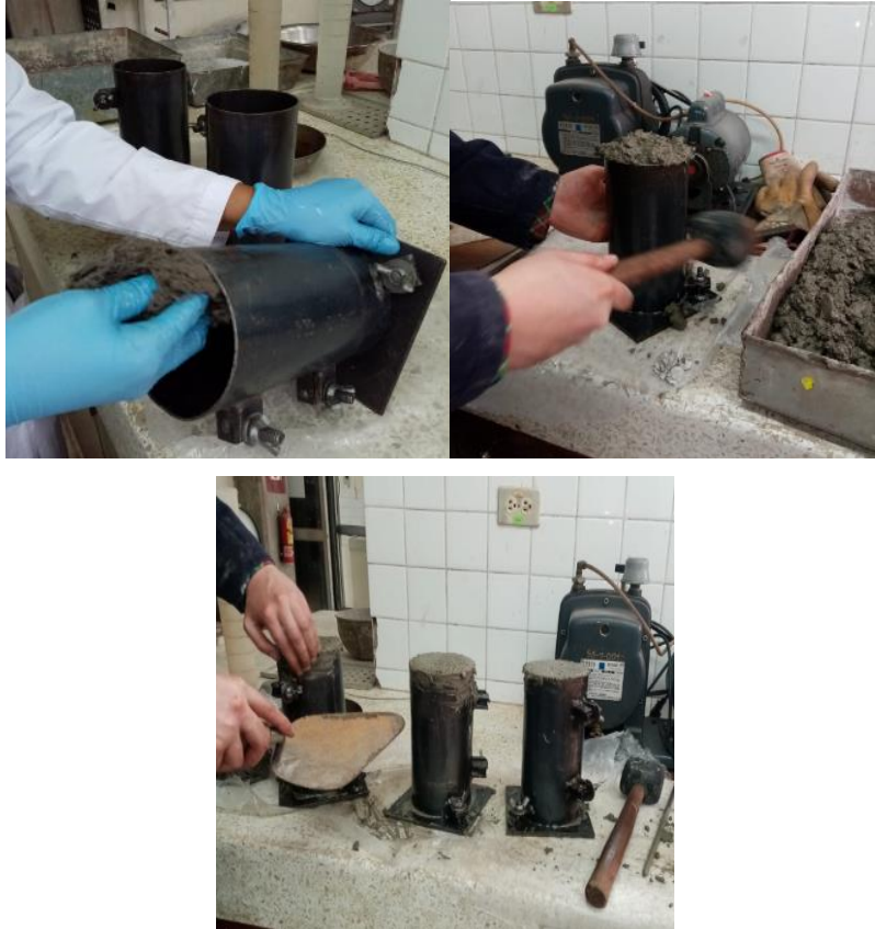
Figura VI.7. Fundición de los cilindros de hormigón
