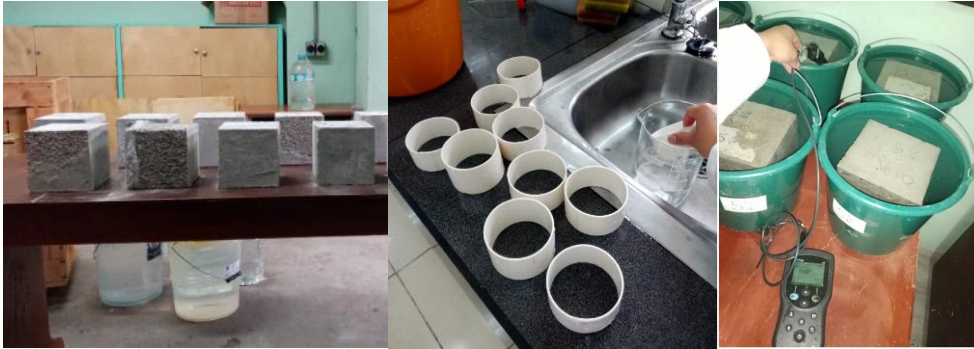
Figura 2.26 Preparación del sistema para la lixiviación en el laboratorio
