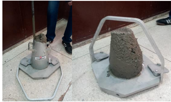
Figura 2.15 Determinación del asentamiento del hormigón
