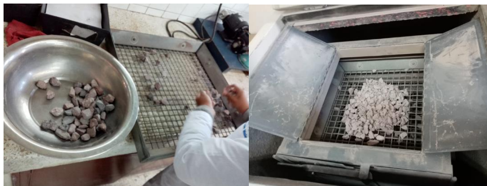
Figura 2.7 Tamizado mecánico del agregado grueso
