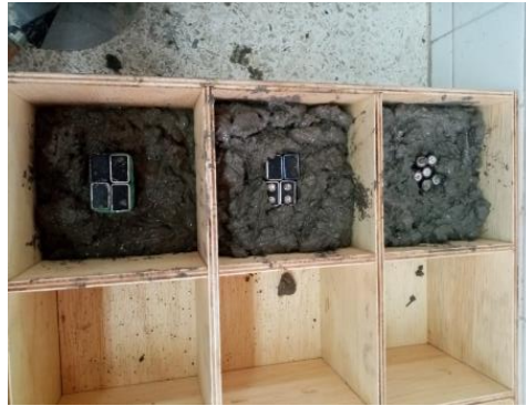
Figura 2.22 Encapsulamiento de las pilas y baterías
