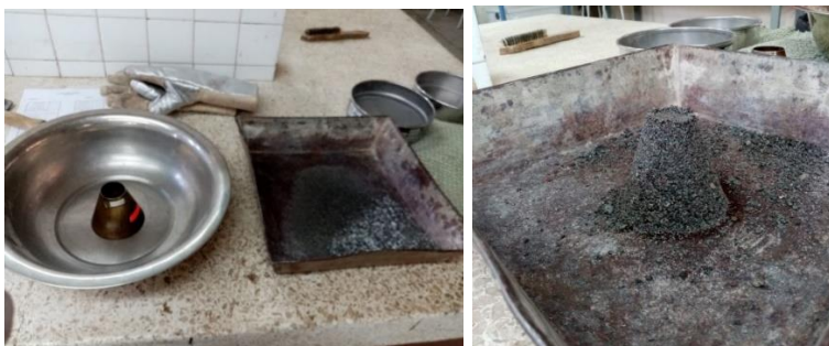
Figura 2.3 Determinación de la densidad aparente del agregado fino (prueba del cono)
