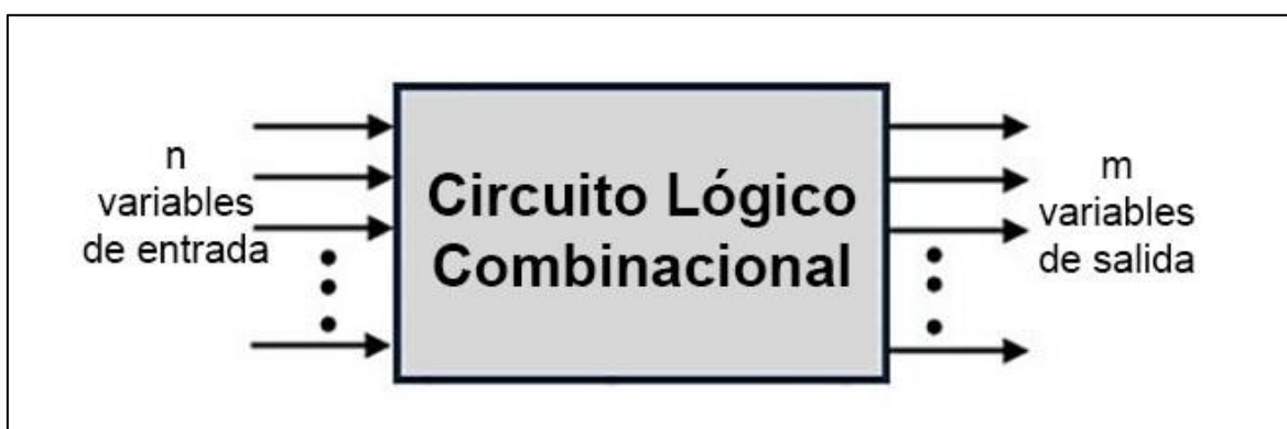
Figura 1.1. Representación Circuito combinacional
