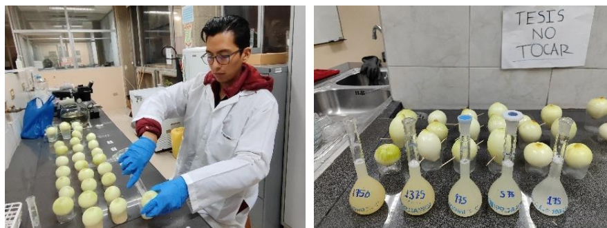
Figura 3.7 Diseño experimental del ensayo de toxicad aguda (120 horas) con la especie Allium cepa
