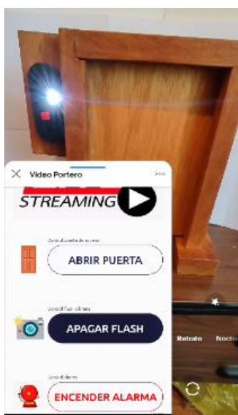
Figura 3.60. Flash encendido mediante Blynk
