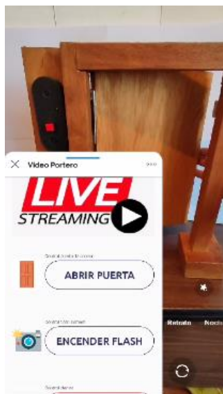
Figura 3.59. Apertura de la puerta mediante Blynk
