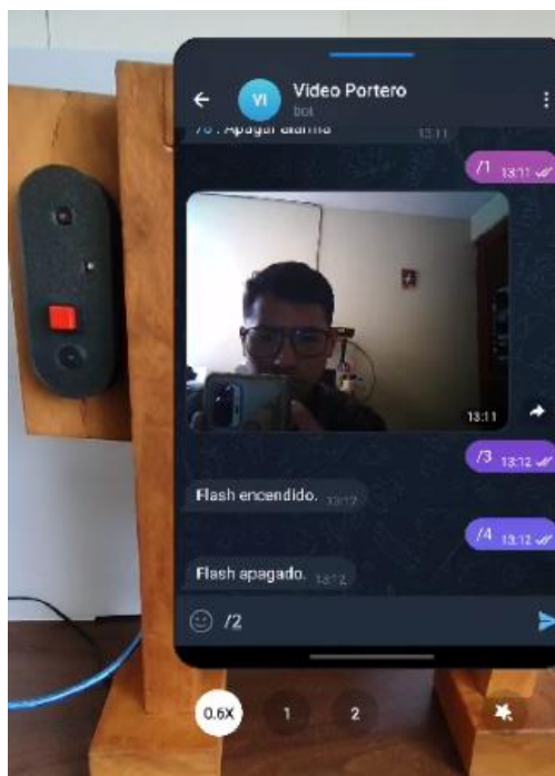
Figura 3.66. Comando para apagar flash en Telegram
