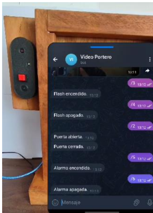
Figura 3.68. Comando para apagar alarma en Telegram
