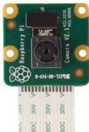
Figura 3.4 Módulo de cámara V2 compatible con Raspberry Pi [13]
