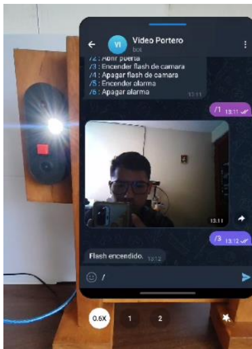
Figura 3.65. Comando para encender flash en Telegram
