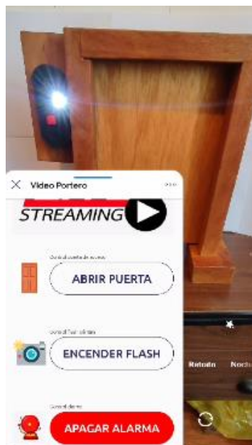
Figura 3.61. Alarma encendida mediante Blynk
