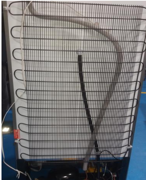
Figura 2.3 Condensador del sistema de refrigeración de CEPUR.
