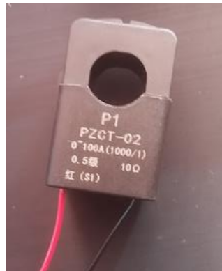
Figura 2.19 Transformador de corriente de relación de transformación mil a uno.
