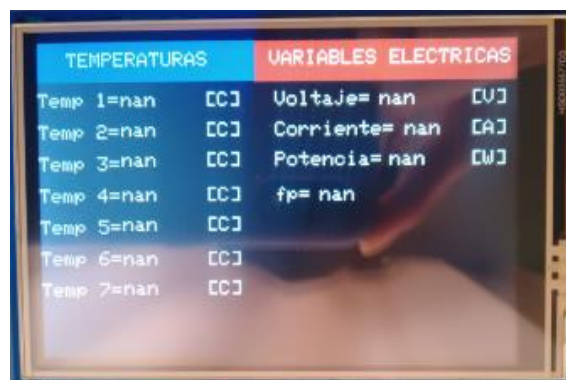
Figura 3.17 Presentación de datos en pantalla con sensores desconectados o sin mediciones.
