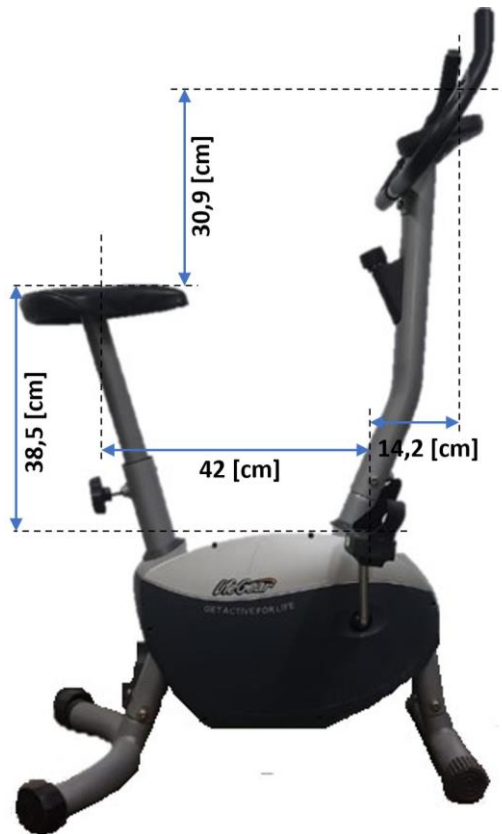
Figura. 2.9 Dimensiones bicicleta estática Fuente Propia
