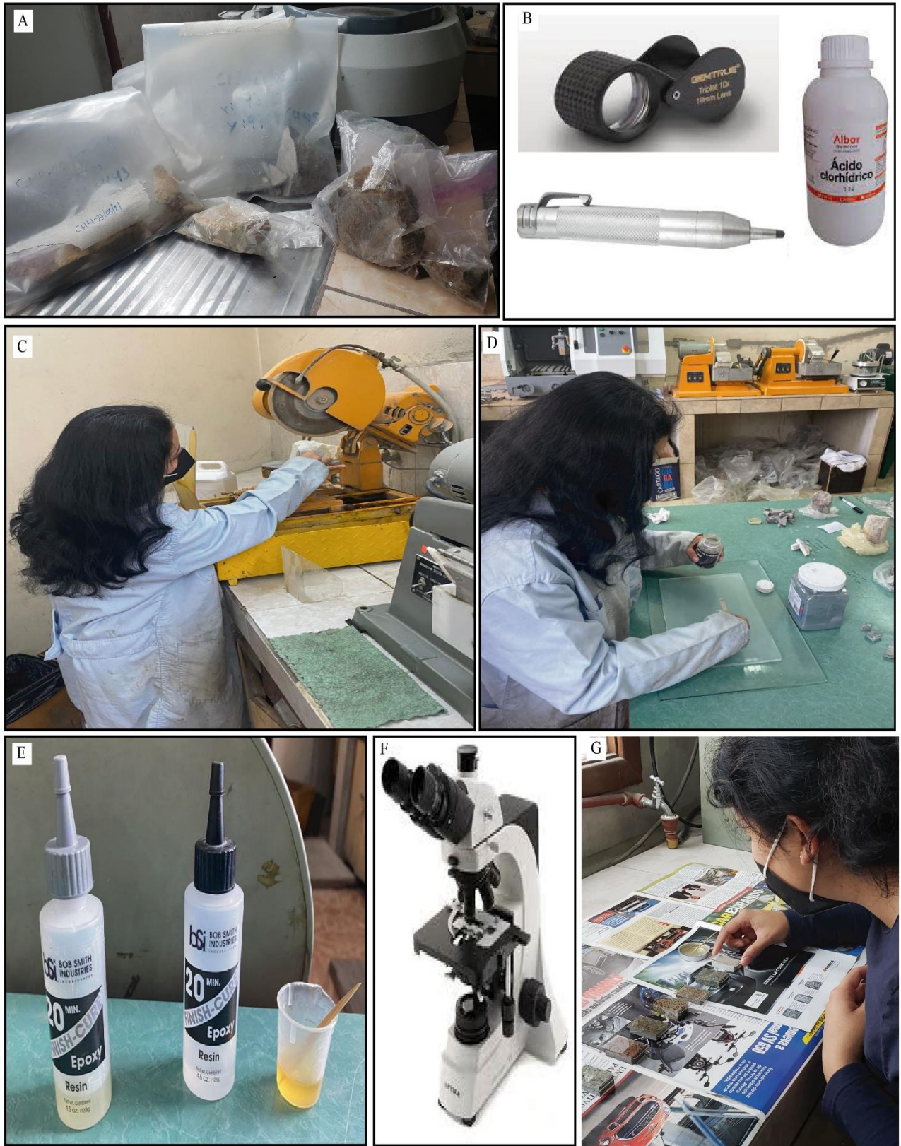
Figura 3.2.1 Procedimiento para elaboración de láminas delgadas A. Selección de muestras. B. Corte de la muestra en chips. C. Pulimento de los chips. D. Secar el chip E. Mezcla de agua y resina F Análisis de microscopio. G. Puesta de cubreobjeto.
