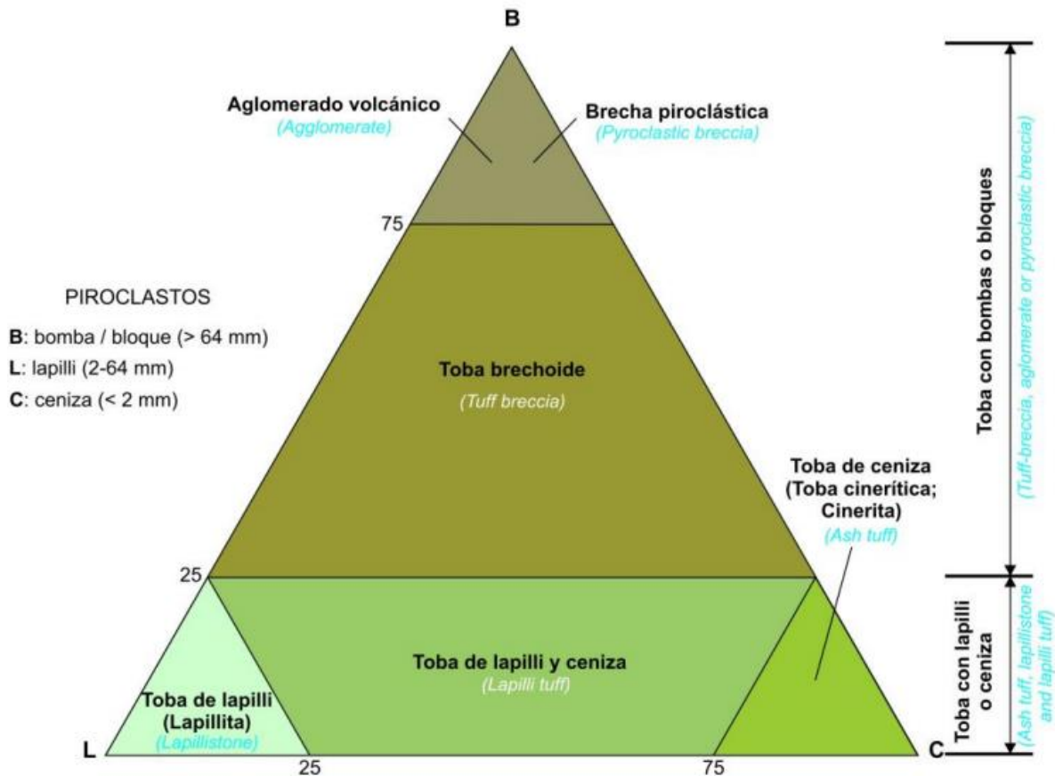
Figura 2.1.1 Clasificación de rocas y depósitos piroclásticos en función de su granulometría. Tomada de (Gillespie & Styles, 1999).
