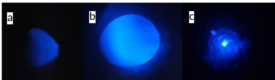
Figura 5: Mancha del haz a) con el cátodo desalineado, b) alineado y c) enfocado.
