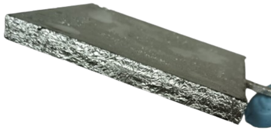
Figura 3: Placa con polvo fosforescente. Se observa la lámina de aluminio frontal.
