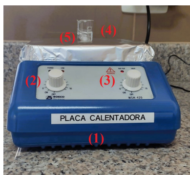
Figura 2.2: Placa calentadora usada para crear las soluciones: (1) Placa calentadora, (2) Perilla de la velocidad, (3) Perilla de la calefacción, (4) Vaso de precipitación de 10 ml, (5) Agitador magnético dentro del vaso.
