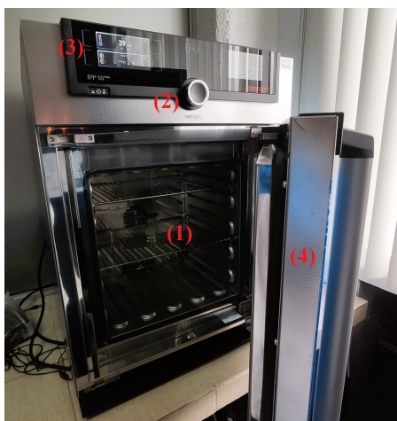
Figura 2.6: Mufla con control de temperatura: (1) Vaso de 10 ml dentro de la mufla, (2) Perilla controladora, (3) Pantalla digital, (4) Puerta hermética.
