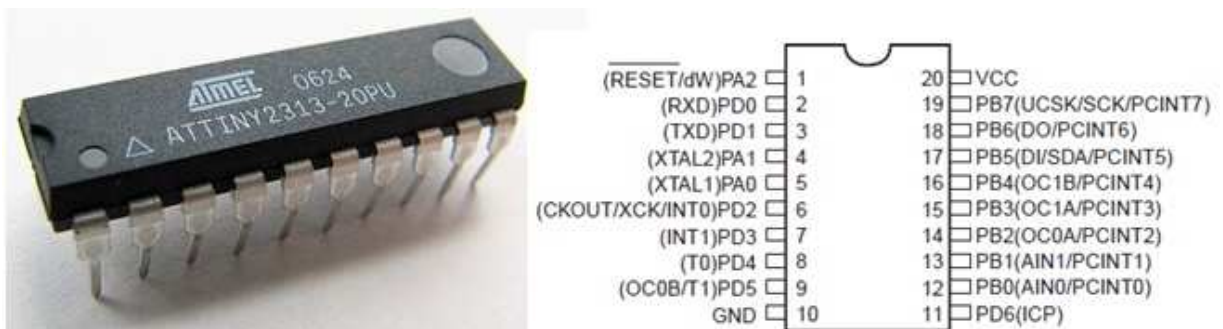
FIGURA 2 - 31 : Distribución de pines microcontrolador ATTINY2313
