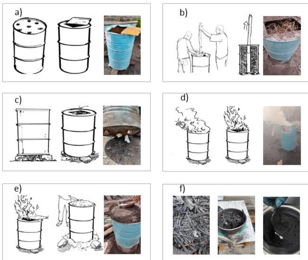
Figura 2.1. Etapas de la pirólisis de biomasa propuesta por el D-Lab MIT. a) adecuación de barrica, b) relleno de biomasa, c) encendido, d) combustión de biomasa, e) aislamiento de aire con arena y f) molienda de carbonilla o biochar. (Fuente: Adaptación de [113])
