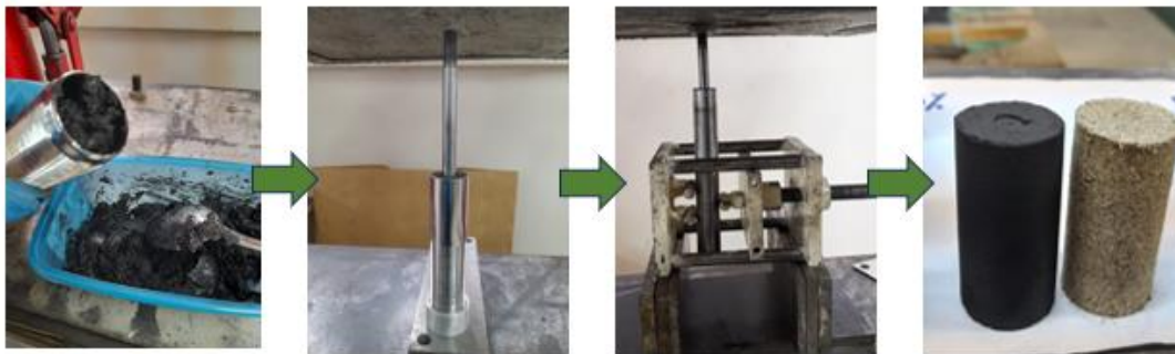
Figura 2.4. Proceso de prensado y extracción de las briquetas. (Fuente propia).
