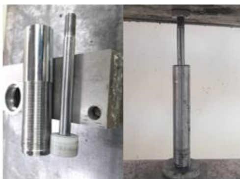
Figura 2.3. Sistema cilindro pistón utilizado en la obtención de briquetas a presiones de 10MPa. (Fuente propia).
