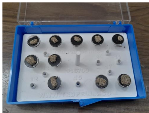
Figura 2.7. Muestras con recubrimiento de oro conductor. (Fuente propia).
