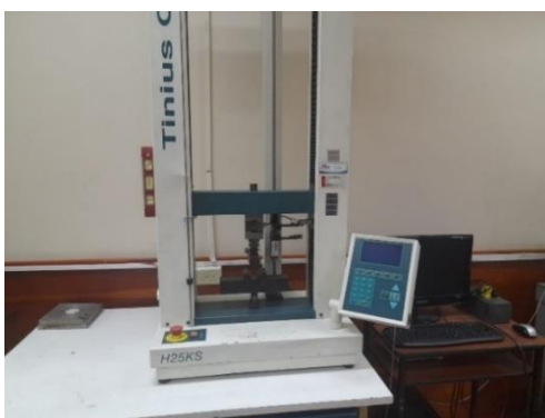
Figura 2.10. Máquina universal de ensayos utilizada en el ensayo de compresión. (Fuente propia).
