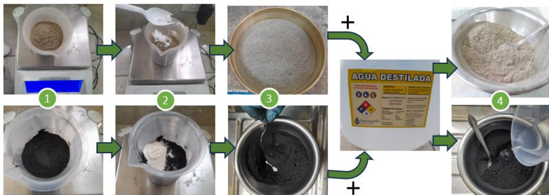
Figura 2.2. Proceso de mezcla para briquetado. 1) medición de materia prima (carbonizada y no carbonizada), 2) adición de aglutinante, 3) mezcla de componentes y 4) adición de agua destilada y mezcla final. (Fuente propia).
