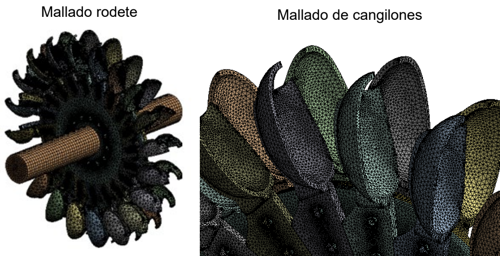
Figura 2.15 Izquierda: Mallado del Rodete completo
