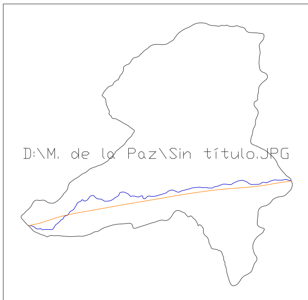
FIGURA 4.14 Longitud real y longitud en línea recta del cauce principal
