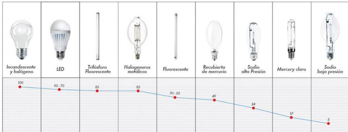
Figura 1.6. Índice cromático de algunas lámparas [11]
