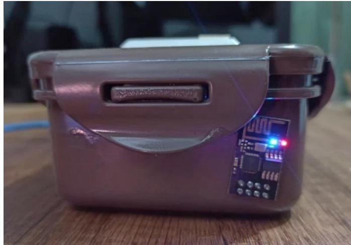
Figura 67. Nodo IoT con el módulo ESP-01 activo
