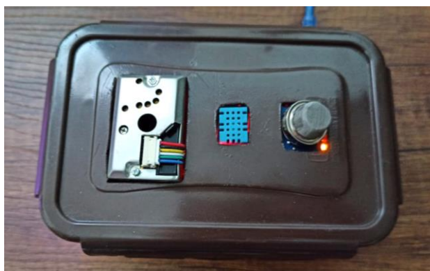
Figura 66. Nodo IoT con los sensores GP2Y1010AU0F, DHT11 y MQ135 activos
