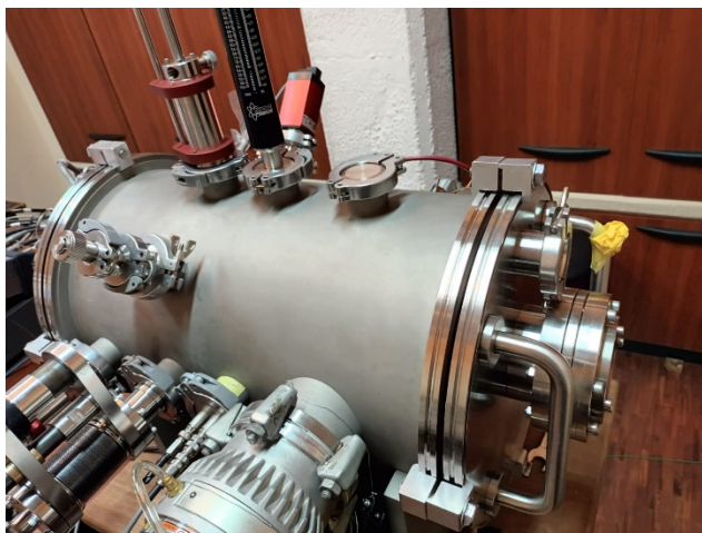
Figura A3. Cámara de vacío. Tiene forma cilíndrica de dimensiones de 54 cm de largo y 34 cm de diámetro.
