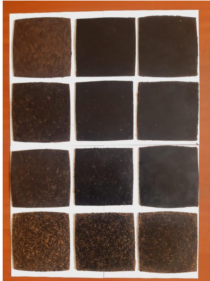
Figura 3.1. Placas de bio-composite elaboradas a distintas condiciones de procesamiento. Al moverse de izquierda a derecha la temperatura de procesamiento cambia en 100 °C, 130 °C y 160 °C. Mientras que al moverse de abajo hacia arriba el tamaño de fibra cambia en valores de malla 20-25, 45-50, 60-70, 70-80.
