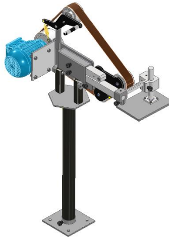
Figura 3.13. Máquina Lijadora de Banda con Pedestal para metal en una posición de trabajo de -45^\circ [Propio].
