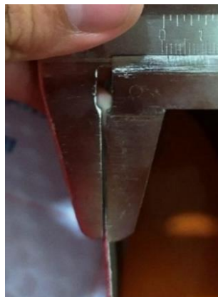
Figura 1.2. Lija de grado cerámico VSM CERAMICS modelo XK870X grano 60 [Propio].
