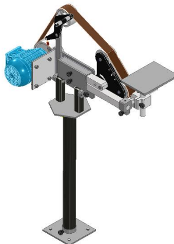
Figura 3.12. Máquina Lijadora de Banda con Pedestal para metal en una posición de trabajo de 45° [Propio].
