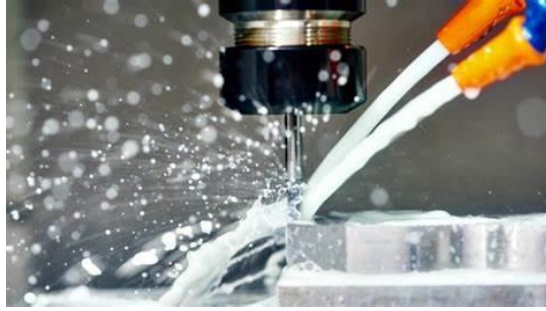
Figura 1.7 Ejemplo de lubricante de corte en acción.
