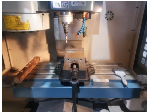
Figura 2.30 Ajuste de broca en el Centro de mecanizado.
