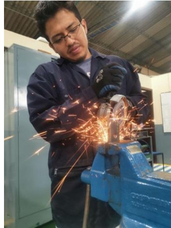
Figura 2.34 Preparación de las probetas para la medición de rugosidad.
