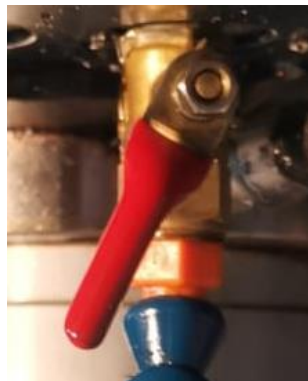
Figura 2.10 Posición de válvula para un nivel de caudal medio.
