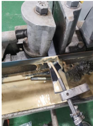
Figura 2.27 Proceso de corte con uso de lubricante.
