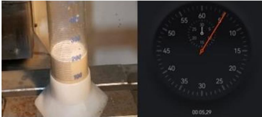
Figura 2.9 Proceso de medición de caudal alto.
