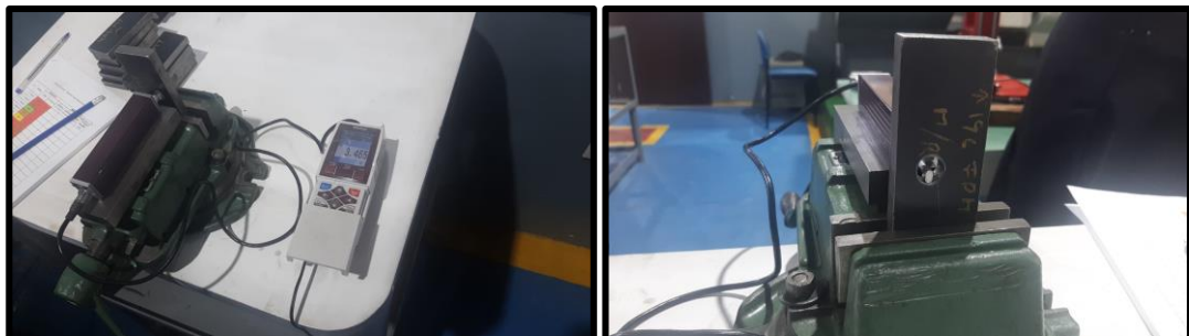
Figura 2.19: Medición Rugosidad Superficial con el Rugosímetro Mitutoyo SJ-20.
