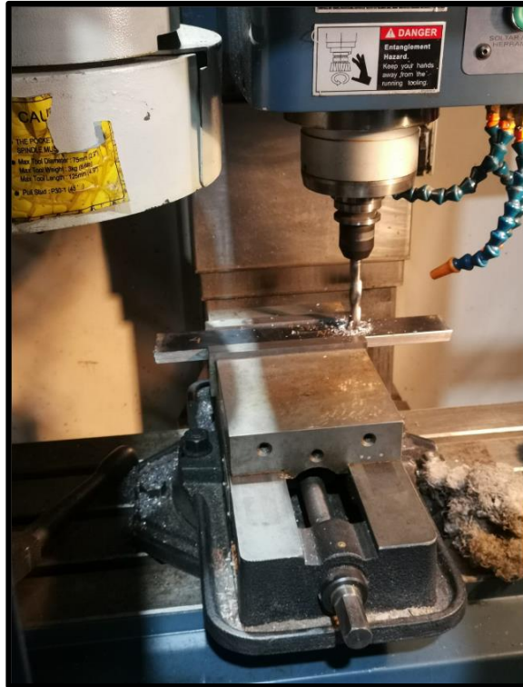
Figura 2.13: Prueba N°3, reduciendo 70 [%] Velocidad ( n ) 30 [%] ( f_n ), sin lubricación.
