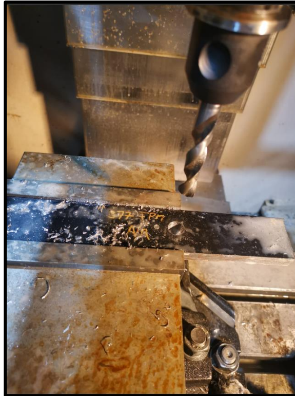
Figura 2.11: Resultado Prueba N°1, valores críticos Velocidad ( n ) y ( f_n ).
