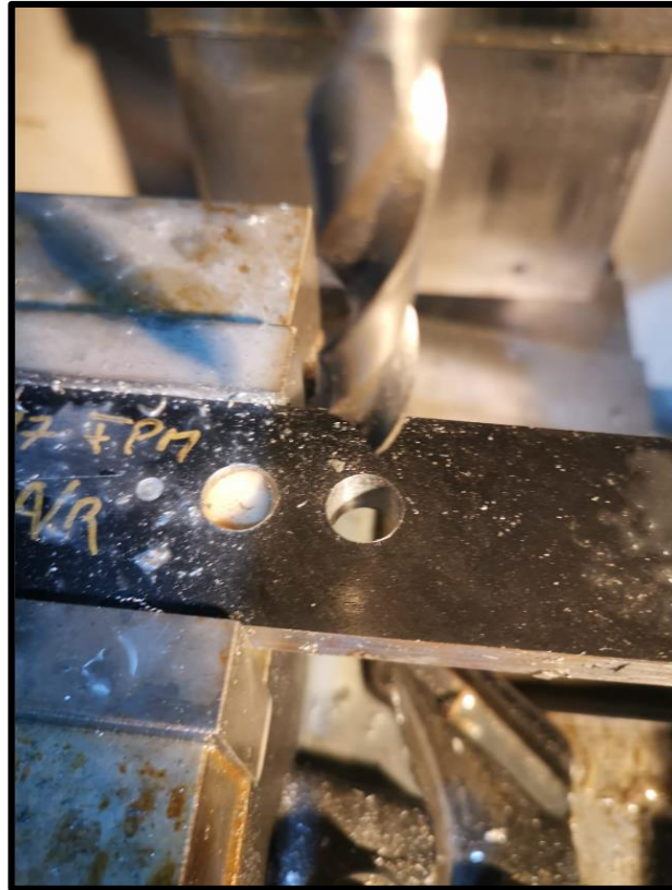
Figura 2.12: Resultado Prueba N°2, reduciendo 70 [%] Velocidad ( n ) 30 [%] ( f_n )
