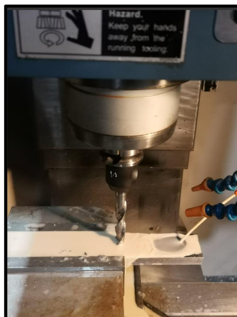
Figura 2.10: Prueba Inicial N°1, valores críticos Velocidad Husillo ( n ) y Avance ( f_n ).
