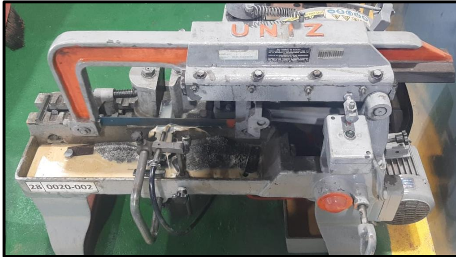
Figura 2.14: Corte de la plancha de Acero ASTM A36, en tramos de 100 [mm].
