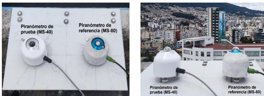
**Figura 5.1.** Instalación de piranómetros en la mesa calibración común, al aire libre (Ejemplo)
