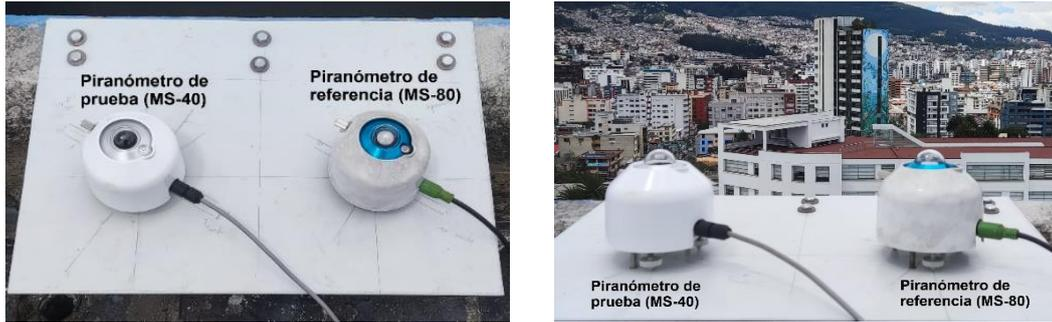
**Figura 2.4.** Instalación de piranómetros en la mesa de calibración común al aire libre
