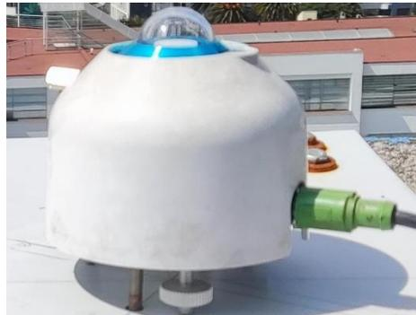
**Figura 1.3.** Piranómetro del tipo termoeléctrico
