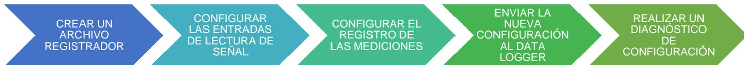
Figura 2.9. Secuencia lógica para configurar un Data Logger
