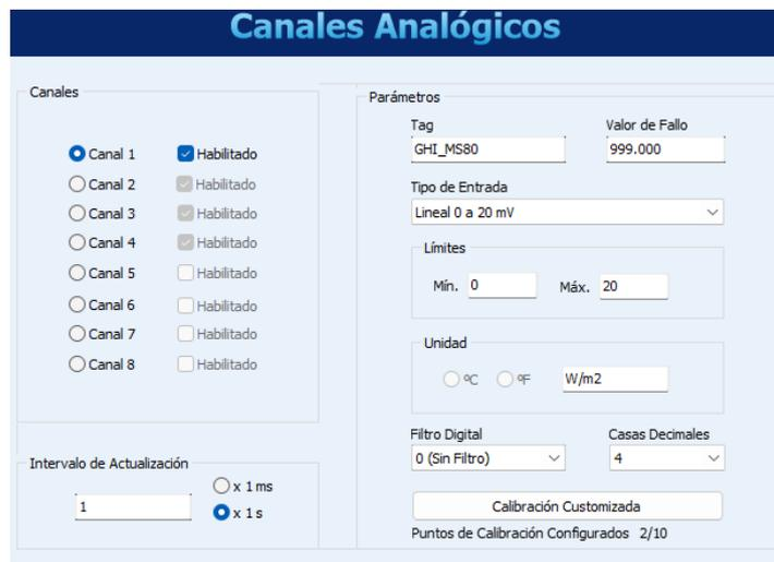
**Figura 5.7.** Configuración de canales analógicos (Ejemplo)
