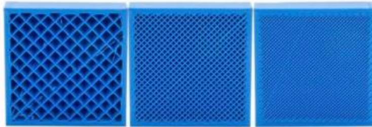
Figura 1.8. Densidad de relleno, 12%, 30% y 50% [8].
