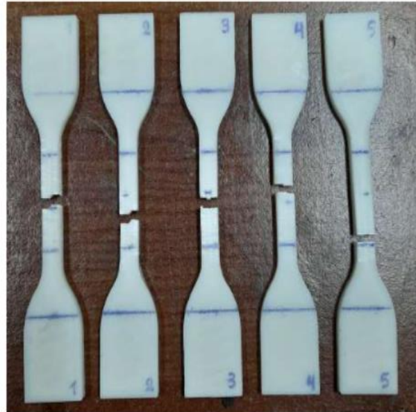
Figura 1. Condiciones finales de las probetas del grupo "STT-T" después de los ensayos de tracción tomando como referencia la norma ASTM D638-14.
