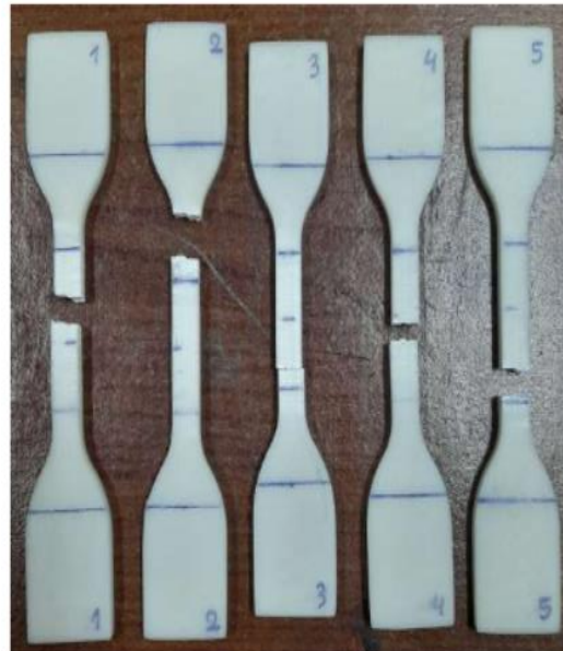
Figura 2. Condiciones finales de las probetas del grupo "CTT-T" después de los ensayos de tracción tomando como referencia la norma ASTM D638-14
