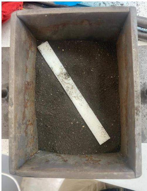
Figura 2.13. Caja cargada con arena y la probeta
