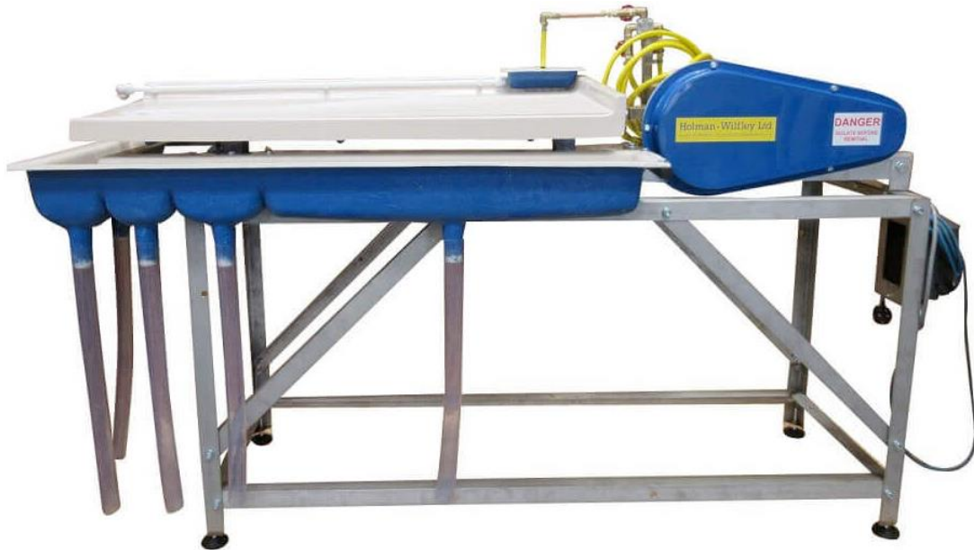
Figura 1. Vista lateral de mesa de separación gravimétrica tipo Wilfley (Rojas, 2018).
