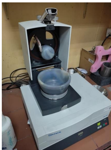
Fig. 9. Molino de ágata utilizado para molienda de las rocas. Se utiliza este tipo de molinos para evitar contaminación de la muestra.
