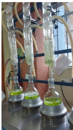
Figura 3.1. Método de extracción por Soxhlet.
