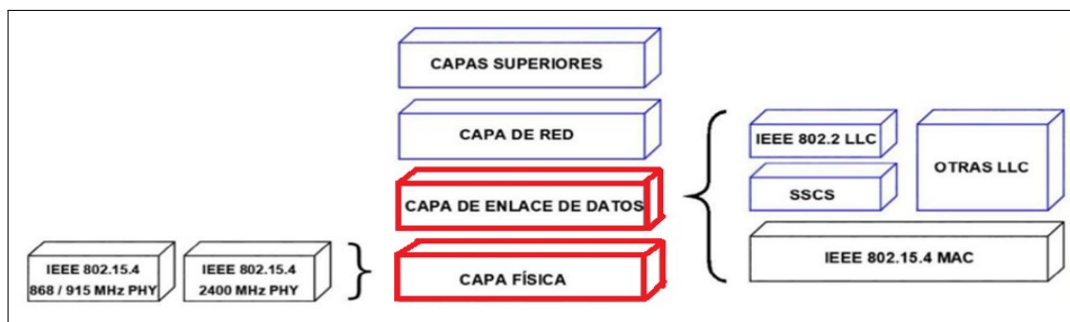
Figura 1.1: Capas del modelo OSI en las que trabaja el protocolo 802.15.4
