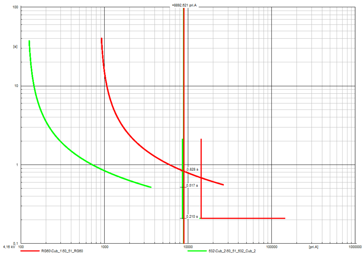
Figura A6.1. Cálculo de falla trifásica sin impedancia de falla al 80% del alimentador LOHL632-633.
