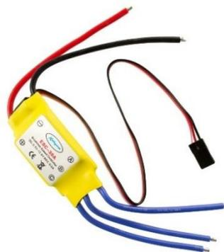
*Fig. 14 Controlador de velocidad electrónico.*
