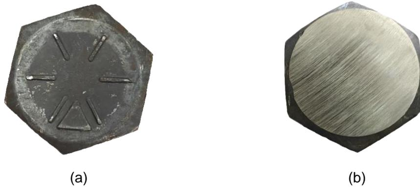
**Figura 2.3.** Eliminación de marcas en la cabra del perno (a) perno con marcas y (b) perno esmerilado (Fuente Propia)
