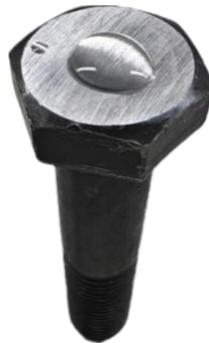
**Figura 2.12.** Colocación de acoplante en el perno (Fuente Propia)
