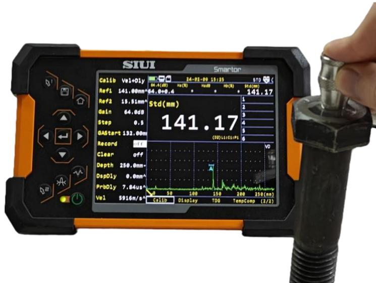
**Figura 2.13.** Calibración del equipo para perno de 141 mm de longitud (Fuente Propia)
