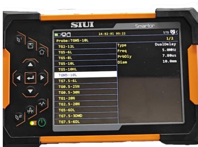
**Figura 2.9.** Especificaciones del transductor (Fuente Propia)
