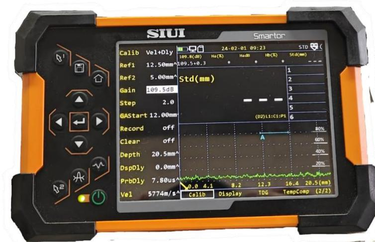
**Figura 2.11.** Menú de Calibración del equipo (Fuente Propia)
