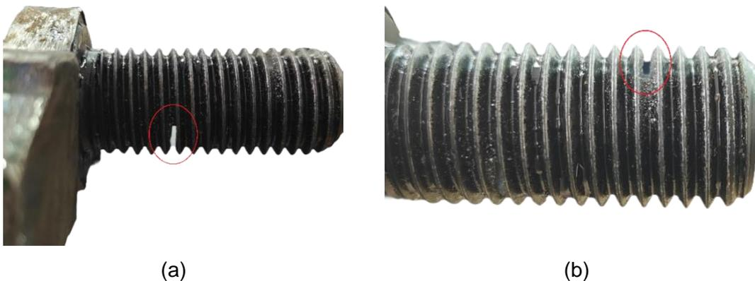
**Figura 2.4.** Discontinuidades por estudiar, (a) muesca de profundidad 3.5 mm, (b) muesca de profundidad 1.75 mm en perno de 2.5 pulgadas.
