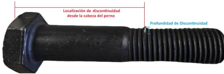
**Figura 2.5** Localización y profundidad de discontinuidad
