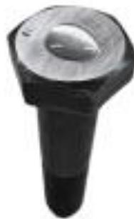
Figura 6. Acoplante en cabeza del perno
