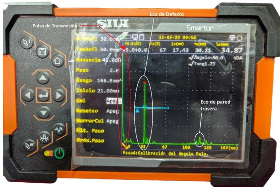
**Figura 1.9.** Distintos picos encontrados en la función de análisis de Soldadura perteneciente al equipo Smartor UT (Fuente Propia)
