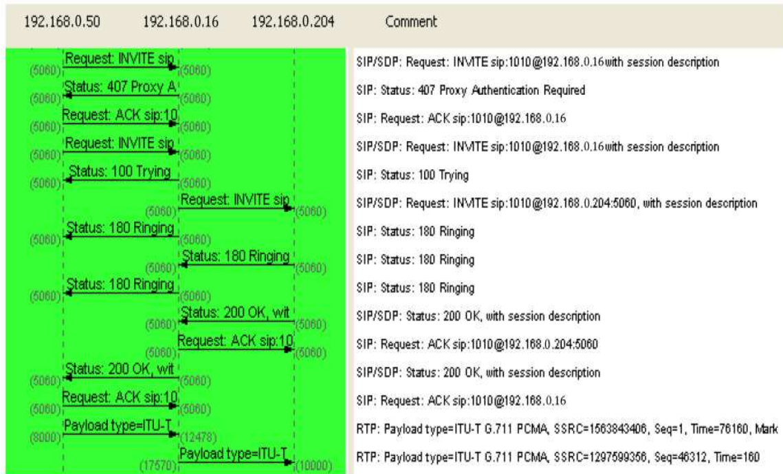
FIGURA 3.3. SIP: FLUJO DE PAQUETES ESTABLECIMIENTO LLAMADA
