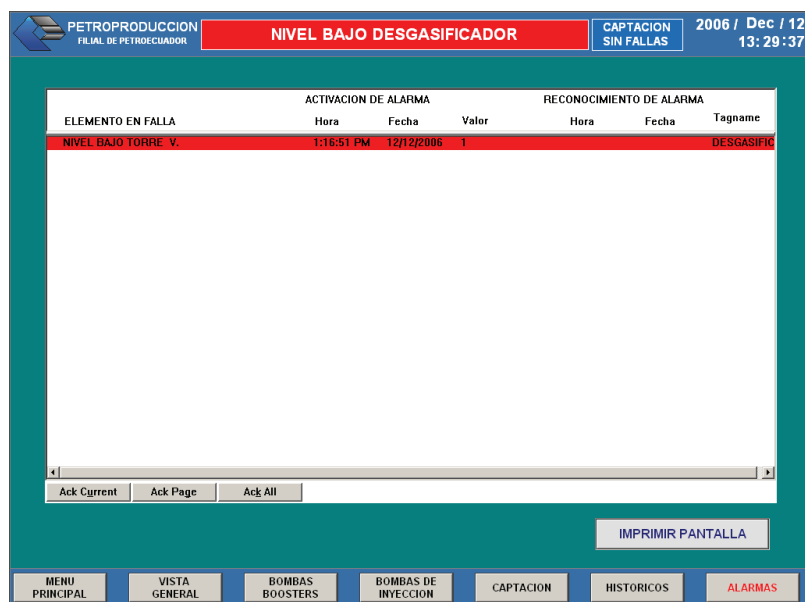
Figura 4.10 Alarma. Nivel bajo desgasificador
