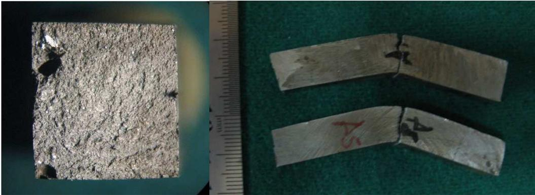
Fotografía 4.2.- Izquierda, Probeta B presenta una porosidad de gran tamaño. Derecha, Probetas testigo de ensayo Charpy.
