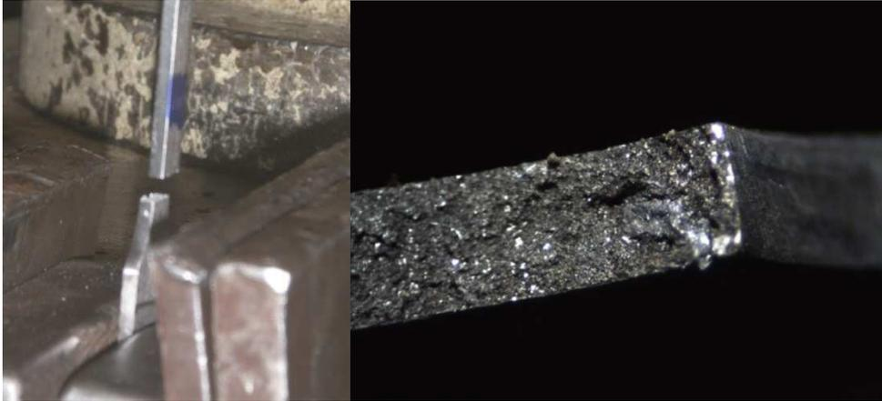
Fotografía 4.4.- Izquierda, Probeta testigo de ensayo de tracción. Derecha, Probeta de ensayo de tracción número 11, perteneciente al tratamiento térmico H.
