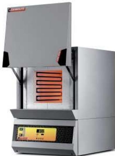
Fotografía 3.6.- Horno mufla, equipo para tratamiento térmico A.
