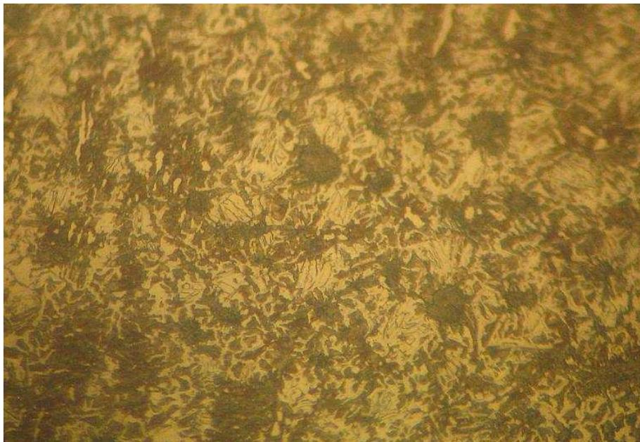
Fotografía 3.11.- Metalografía de prueba preparatoria, probeta templada desde 800°C, 400x.
