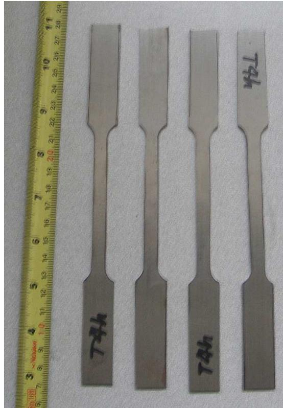
Fotografía 3.17.- Probetas de tracción.
