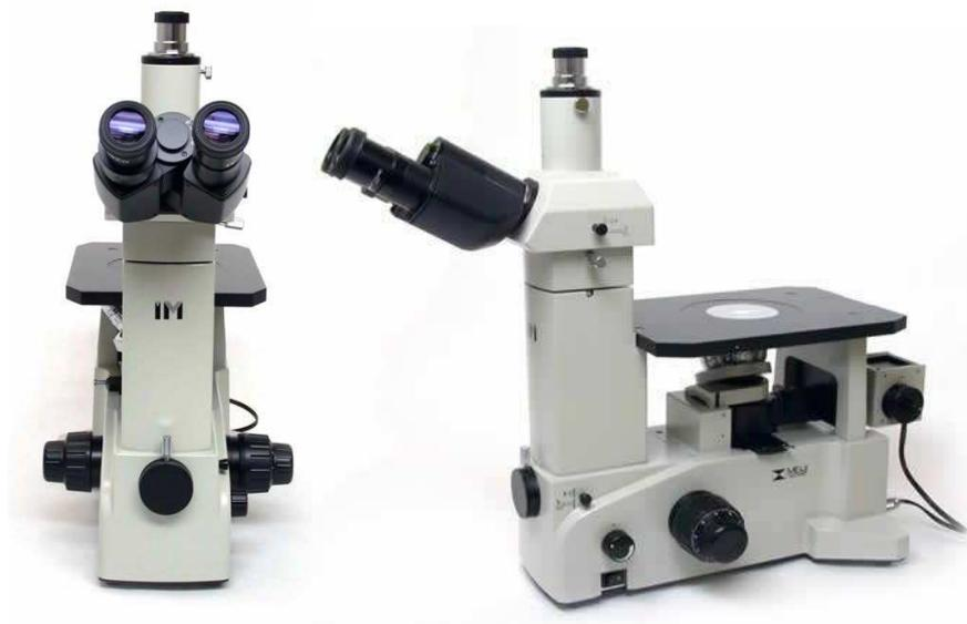
Fotografía 3.7.- Microscopio metalográfico utilizado en la experimentación.
