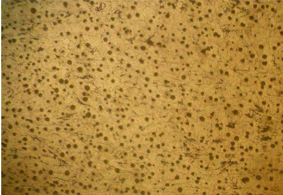
Fotografía 3.2.- Metalografía de material base transversal a 100x de aumento.
