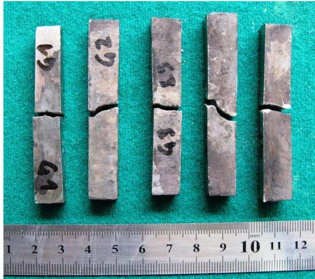
Fotografía 3.5.- Probetas para ensayo Charpy.
