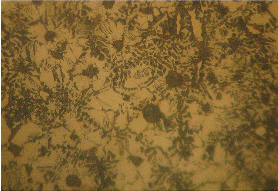
Fotografía 3.12.- Metalografía de prueba preparatoria, probeta templada desde 900°C, 400x.
