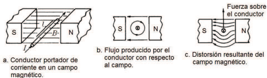
Figura 1.3. Conductor de longitud l que lleva una corriente I en un campo magnético B , y desarrolla una fuerza resultante F .
