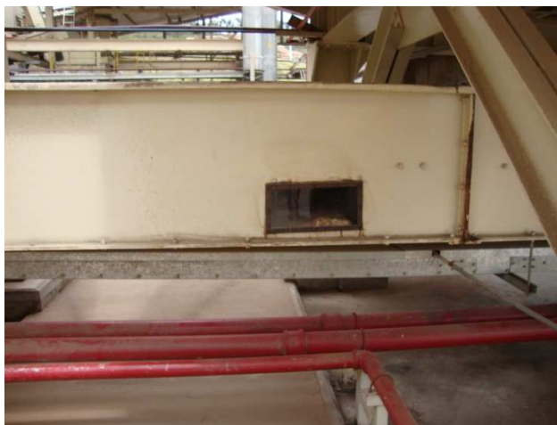
FIGURA 3.14 TRANSPORTE DE MATERIAL HÚMEDO DESDE LOS SILOS HACIA EL TUBO FLASH DEL SECADERO
