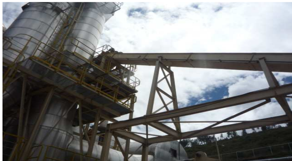
FIGURA 2.11 CONDUCTO DE INGRESO DE LOS CHIPS DE MADERA HACIA EL TAMBOR DEL SECADERO
