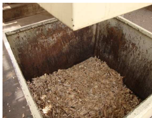
FIGURA 3.18 DESCARGA DE MATERIAL GRUESO DESDE EL TUBO FLASH DEL SECADERO
