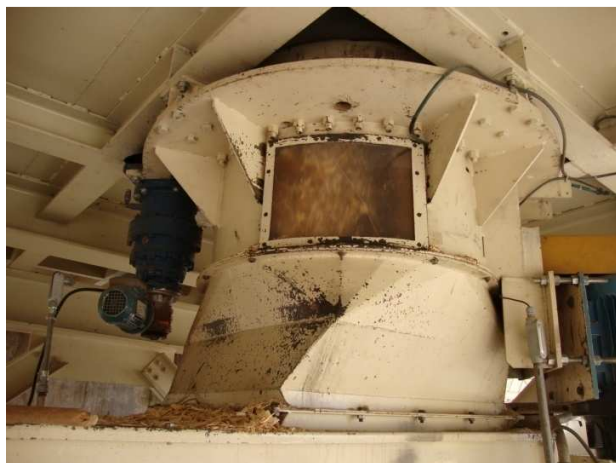
FIGURA 3.12 DESCARGA DE MATERIAL HÚMEDO DESDE LOS SILOS HACIA LA BANDA TRANSPORTADORA
