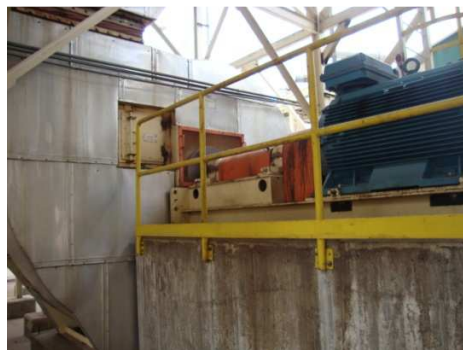
FIGURA 3.3 MOTOR DEL FAN PRINCIPAL DEL PROCESO DE SECADO
