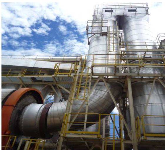
FIGURA 2.11 CONDUCTO DE INGRESO DE LOS CHIPS DE MADERA HACIA EL TAMBOR DEL SECADERO
