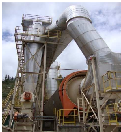
FIGURA 3.25 TUBO DE SUCCIÓN DE MATERIAL HACIA EL GRUPO DE CICLONES
