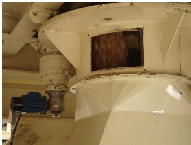
FIGURA 3.12 DESCARGA DE MATERIAL HÚMEDO DESDE LOS SILOS HACIA LA BANDA TRANSPORTADORA
