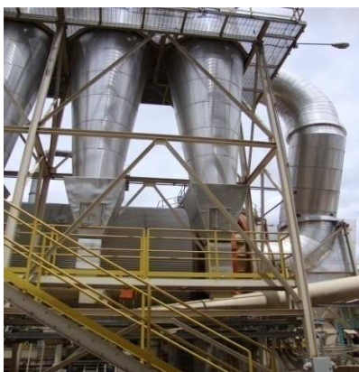
FIGURA 3.25 TUBO DE SUCCIÓN DE MATERIAL HACIA EL GRUPO DE CICLONES
