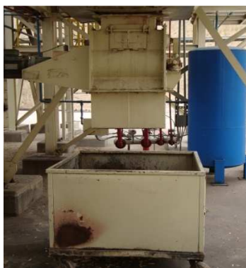
FIGURA 3.18 DESCARGA DE MATERIAL GRUESO DESDE EL TUBO FLASH DEL SECADERO
