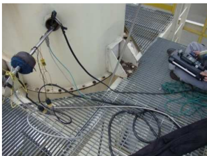
FIGURA 4.14 MONITOREO DE GASES PRODUCTOS DEL PROCESO DE SECADO
