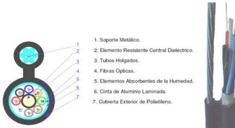
Figura 2.7 Fibra óptica monomodo
