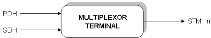
Figura 2.4 Multiplexor Terminal de una red SDH
