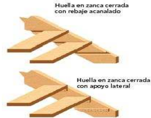
Fig. 5.52 Tipos de apoyo para huellas en la zanca
