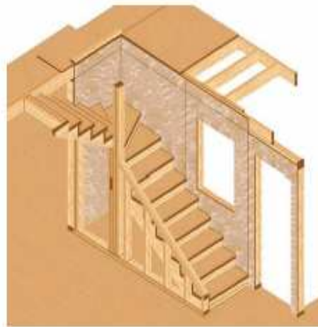
Fig. 5.59 Ubicación del tabique lateral de apoyo y fijación de la estructura de la escalera. Bajo el segundo tramo se puede observar un vano de puerta que dará lugar a un clóset bajo la escalera
