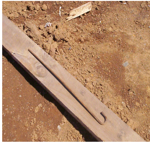
Fig. 5.14 Varilla lisa de 8 mm, gancho de 5 cm., longitud total 30 cm
