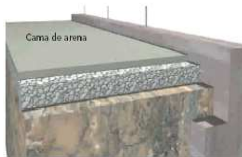
Fig. 5.18 Colocación de cama de arena sobre el ripio
