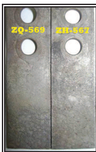
Figura3.15 Cupones evaluados luego de ser pesados y lavados pozo 15
