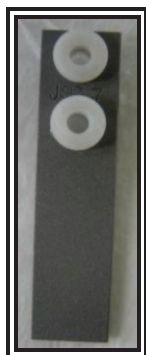
Figura 1.6. Esquema de cupón de corrosión (NACE, 2005).
