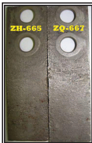
Figura3.14 Cupones evaluados luego de ser pesados y lavados pozo 09
