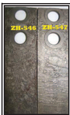
Figura3.10 Cupones evaluados luego de ser pesados y lavados pozo 06
