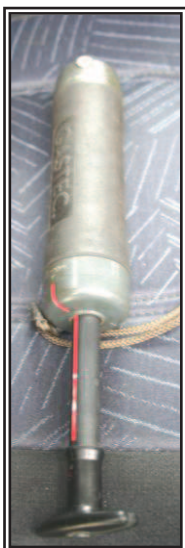
Figura 2.7. Bomba tipo SENSIDYNE 100 ml de capacidad
