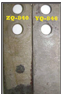
Figura3.11 Cupones evaluados luego de ser pesados y lavados pozo 14
