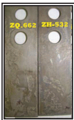
Figura3.12 Cupón evaluado luego de ser retirado y lavados pozo 20
