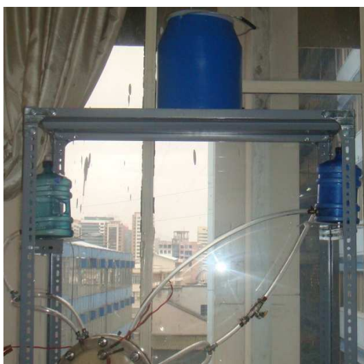
Figura 5.7 Adaptación para la medición de gas producido.
