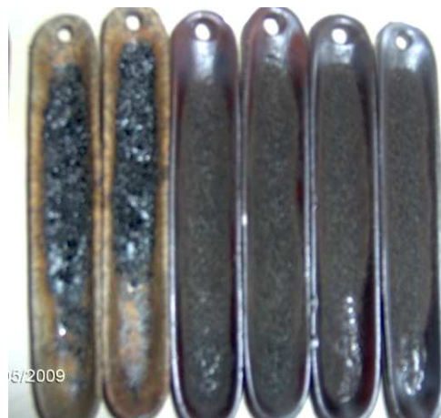
Figura A6. Escoria de incombustos calcinadas a 850, 900 y 950 °C
