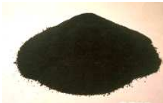
Figura 3.1. Cenizas volantes producidas por la combustión del fuel oil residual. Recogidas de bandejas ubicadas rumbo a la chimenea
