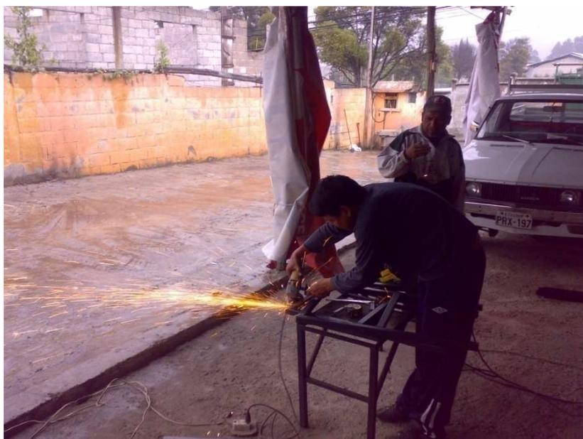
Figura 3.20 Corte de los perfiles estructurales
