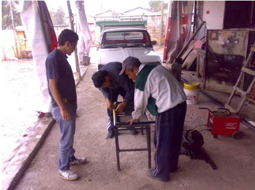
Figura 3.24 Montaje de la estructura de la cámara de desvainado.
