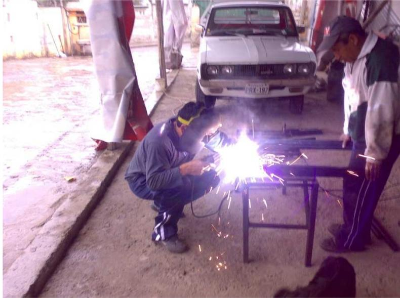
Figura 3.21 Soldadura de los perfiles estructurales
