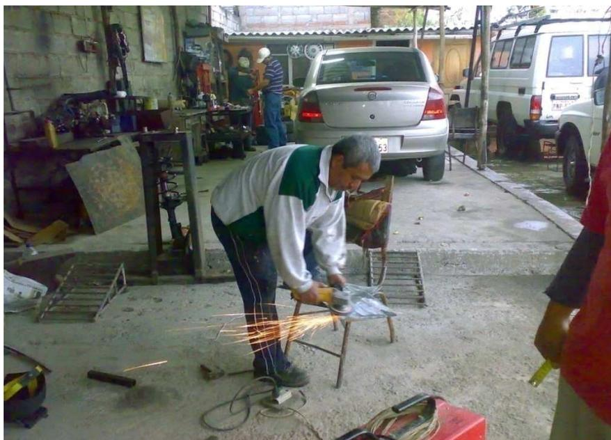
Figura 3.19 Corte de las placas metálicas
