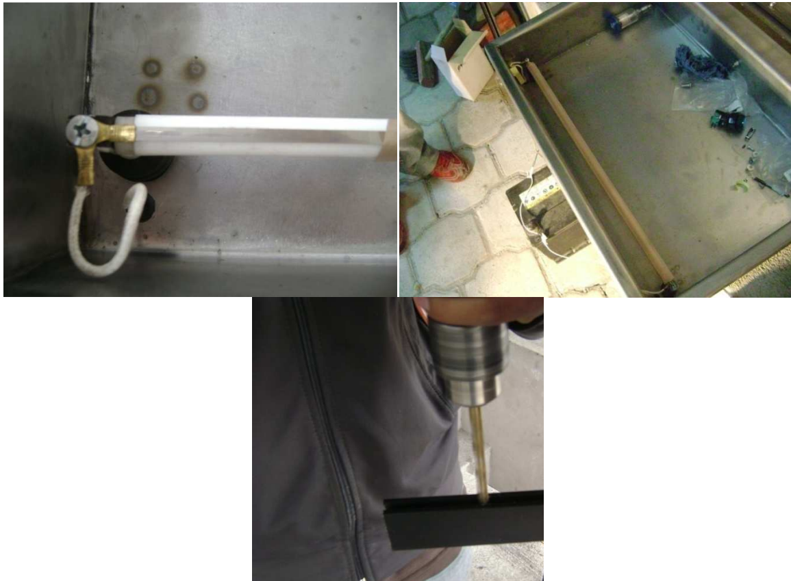
Figura 84 Construcción de la barra de sellado
