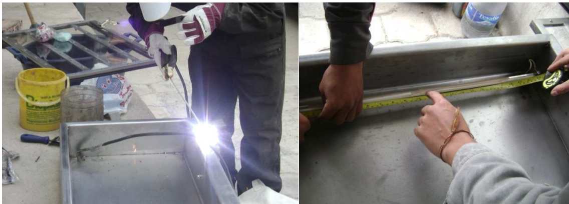
Figura 81 Construcción de la cámara de vacío
