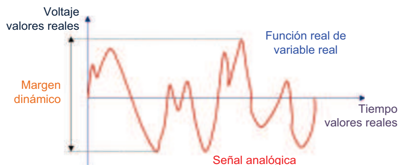
Figura 1. 20 Representación de una señal analógica (señal eléctrica)
