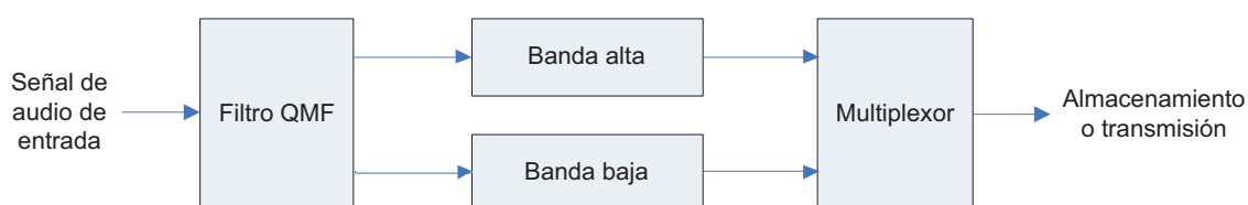
Figura 2. 7: Diagrama de bloques de un codificador ADPCM
