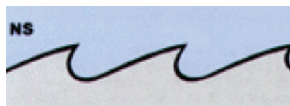
Figura 3.6 Forma de los dientes de la sierra de cinta
