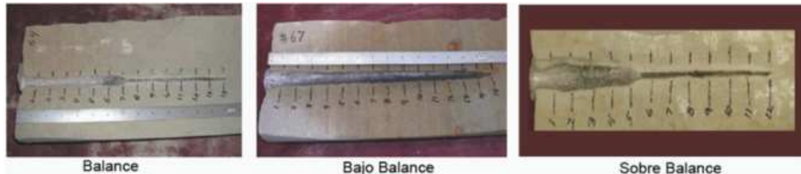
GRÁFICO 1.24 DISPAROS EN BALANCE, BAJO BALANCE Y SOBREALANCE
